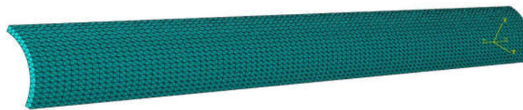
Slika 3.12: Cijev diskretizirana hibridnim tetraedarskim konačnim elementima
