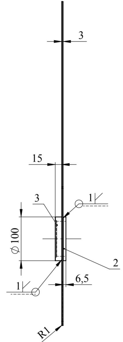
Napomena: Na bridovima cilindra 3 i 4, koji se zavaruju s desnom bočnom pločom, prethodno napraviti skošenje  $1x30^\circ$ . Cilindričnu plohu desne bočne ploče omeđenu zavarima te obraditi na hrapavost površine Ra 1,6.
