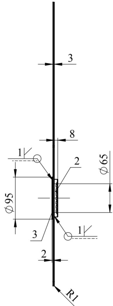
Napomena: Na bridovima cilindra 1 i 2, koji se zavaruju s desnom bočnom pločom, prethodno napraviti skošenje 1x30°.
