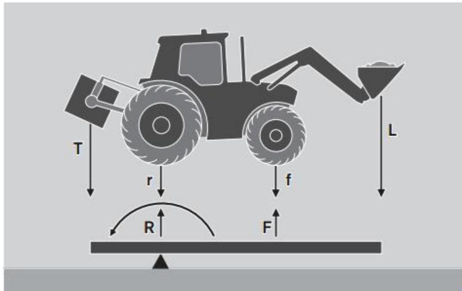
Slika 21. Analogija oslonca kod proračuna opterećenja osovine traktora
