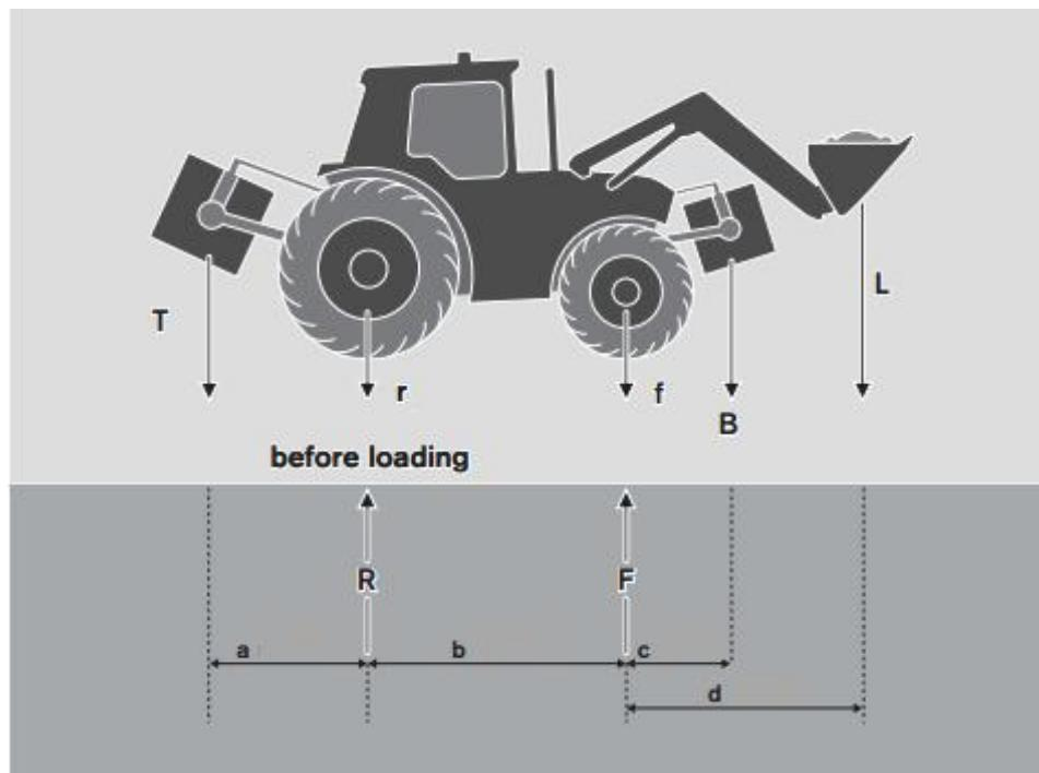
Slika 19. Opterećenja traktora i udaljenosti opterećenja od osovina
