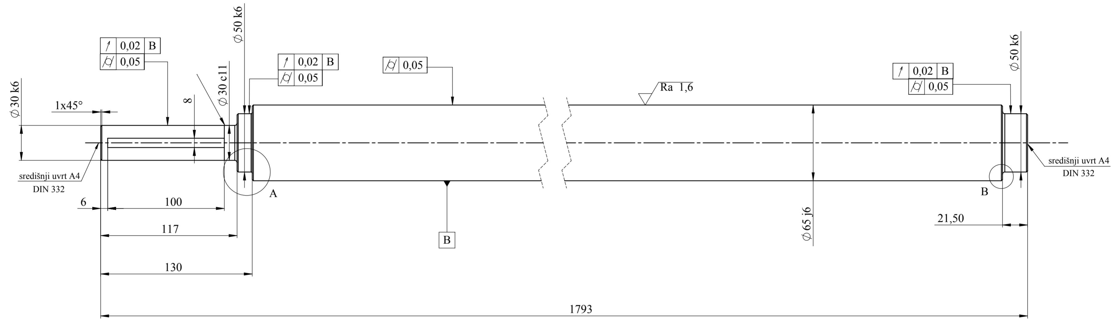
Napomena: Na bridovima cilindra, koji se zavaruju s pločom 1 prethodno napraviti skošenje 1x30°.
