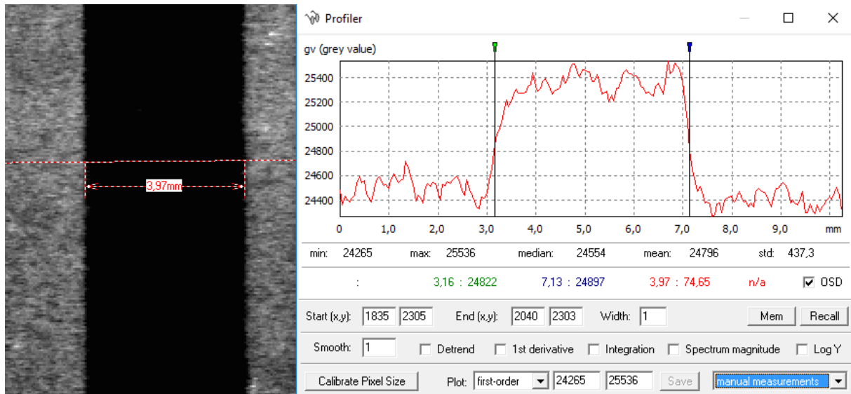
Slika 40. Mjerenje širine utora pomoću Profiler-a u zoni mjerenja 1.2 za Blue 50um
