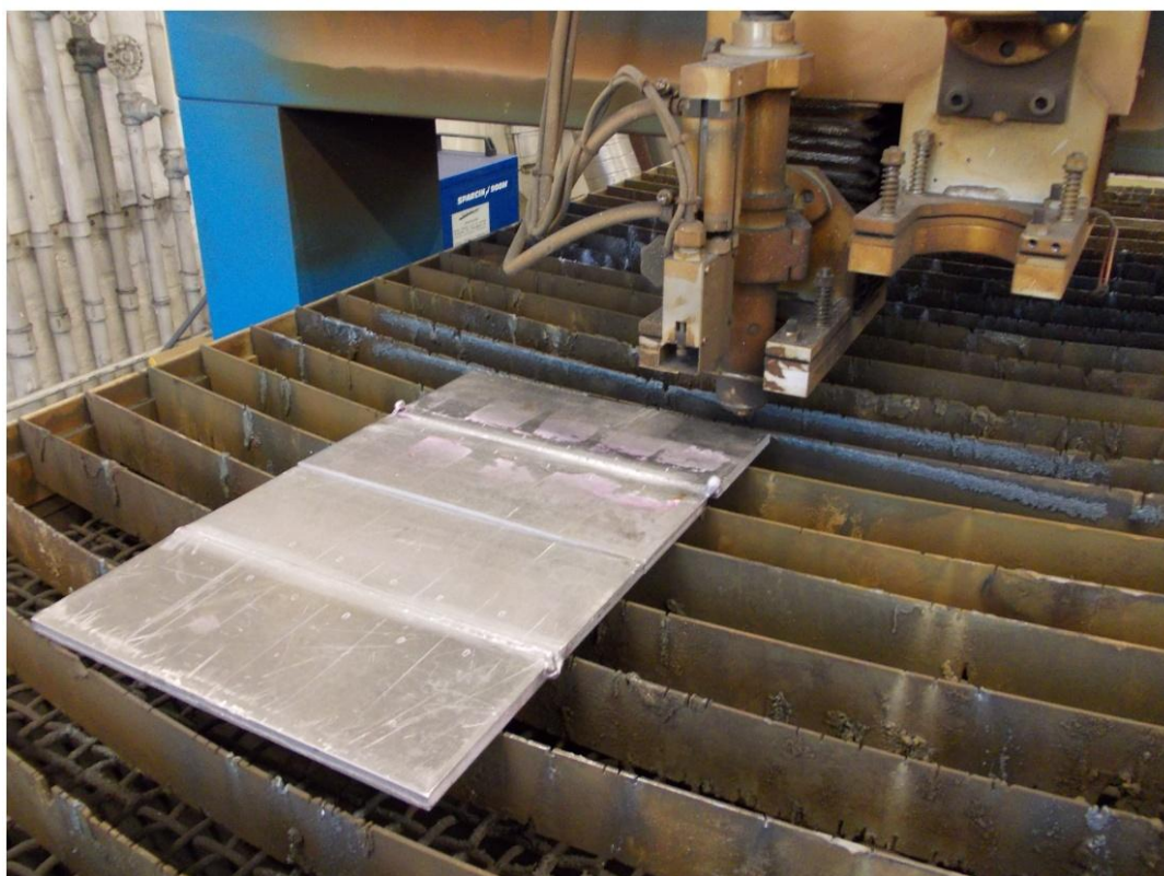
Slika 29. Priprema za rezanje ispitnih uzoraka
