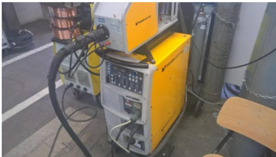
Slika 16. Izvor struje za zavarivanje Welbee P400
