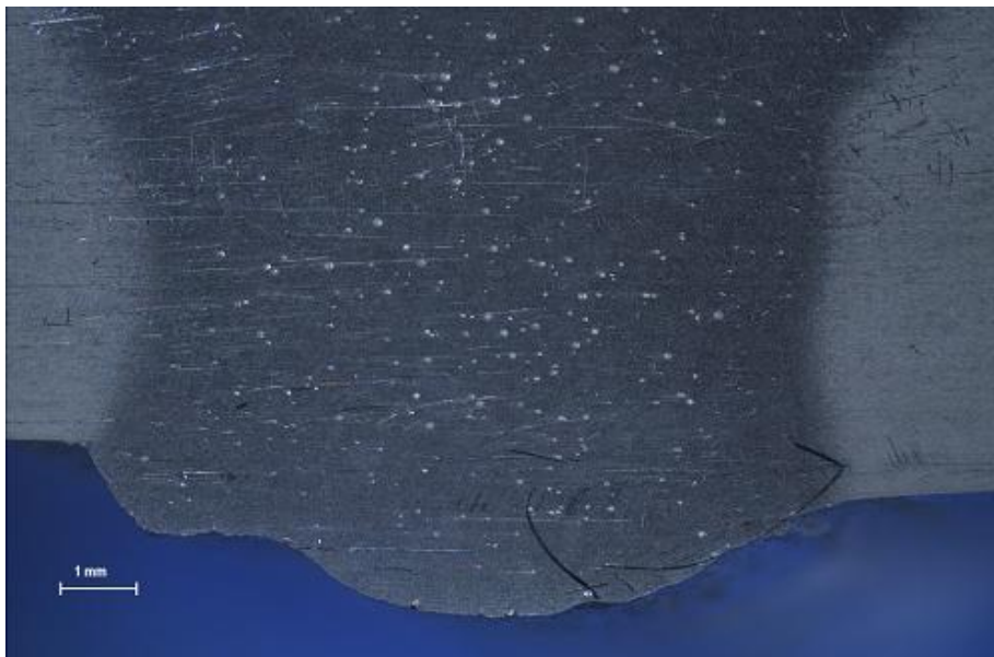
Slika 36. Mikroskopska analiza uzorka A – detalj korijen zavara
