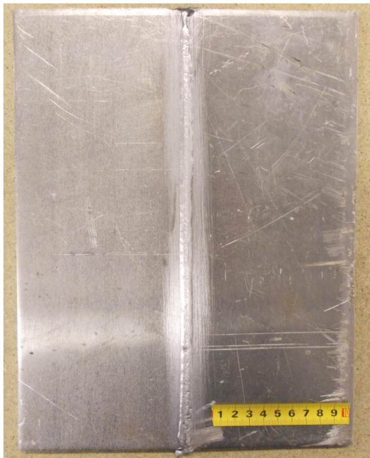
Slika 23. Korijen zavara uzorka B
