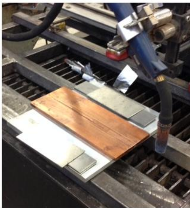
Slika 19. Prikaz bakrene podloge
