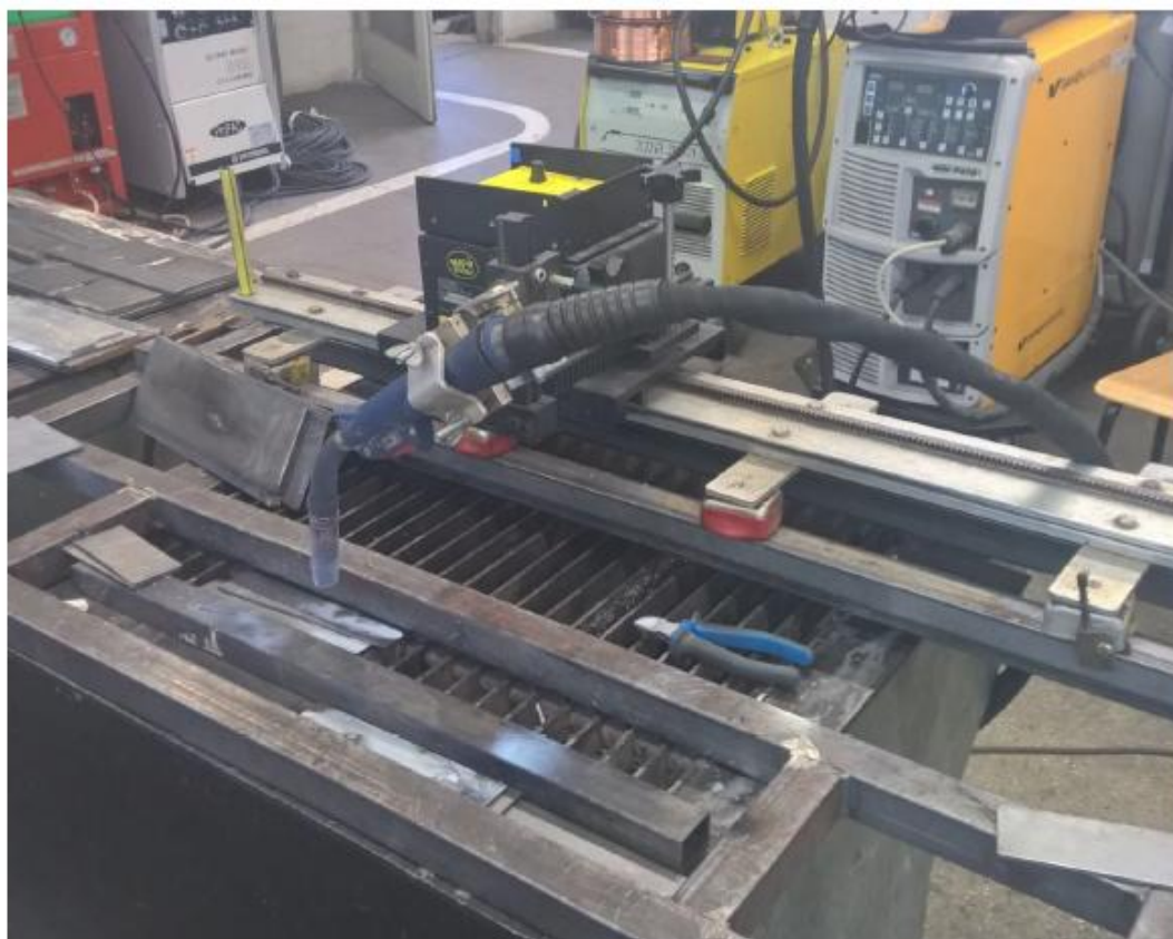
Slika 17. Uređaj za automatizirano gibanje pištolja
