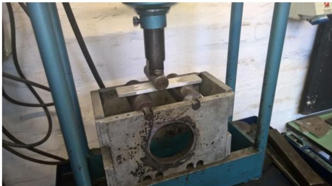
Slika 31. Prikaz ispitivanja savijanjem u Laboratoriju za zavarivanje na FSB [30]
