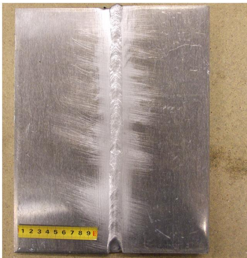
Slika 20. Lice zavara uzorka A
