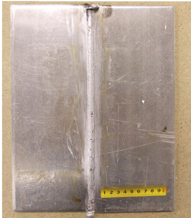
Slika 21. Korijen zavara uzorka A
