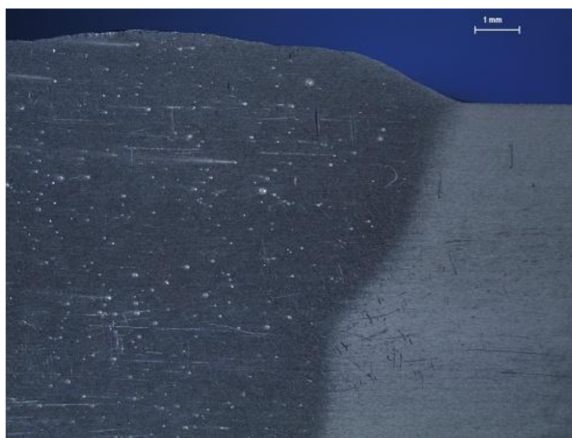
Slika 35. Mikroskopska analiza uzorka A – detalj lice zavara, desno
