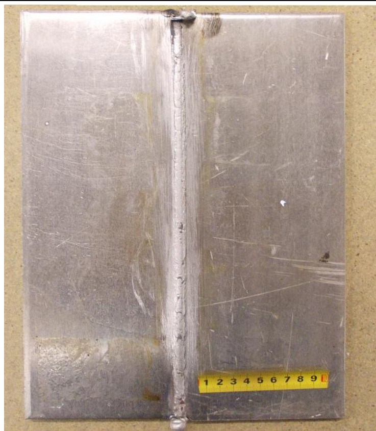
Slika 21. Korijen zavara uzorka A
