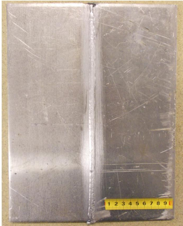
Slika 23. Korijen zavara uzorka B
