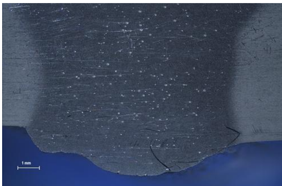
Slika 36. Mikroskopska analiza uzorka A – detalj korijen zavara
