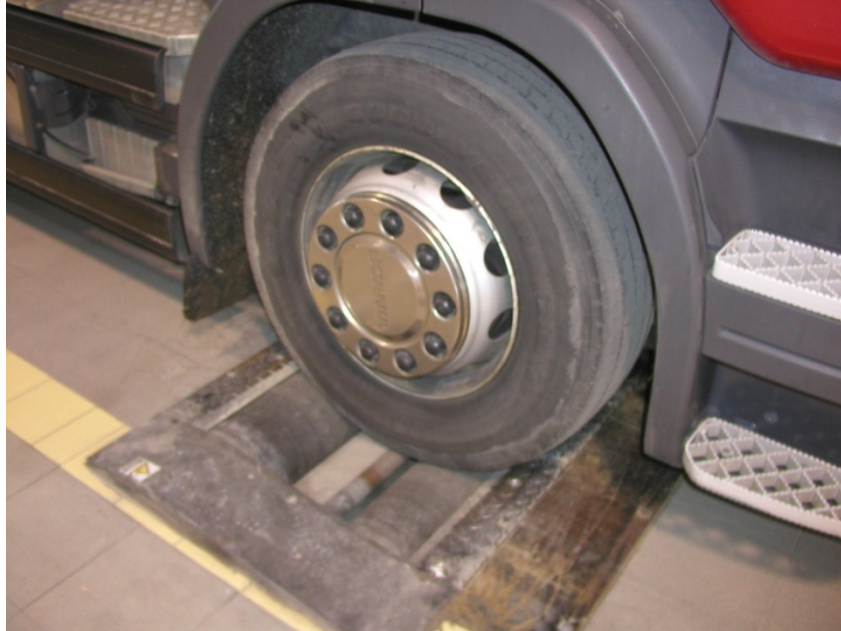
Slika 10.22 Prednja osovina na valjcima za mjerenje sile kočenja
