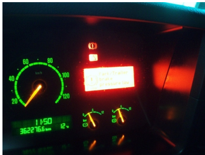
Slika 10.14 Upaljena kontrolna lampica u kabini vozača
