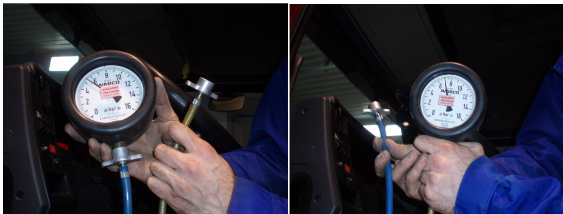
Slika 10.17 Tlak u drugom kočnom krugu kod ispražnjenog prvog kruga (lijeva slika) i tlak u prvom kočnom krugu kod ispražnjenog drugog kruga (desna slika)
