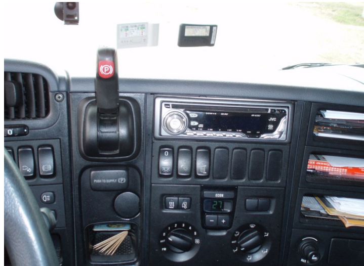
Slika 10.6 Poluga parkirne kočnice u otpuštenom položaju
