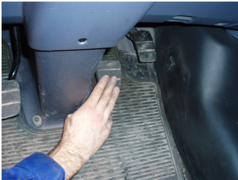
Slika 10.16 Provjera hoda papučice glavnog kočnog ventila
