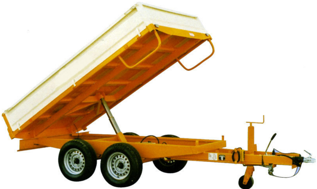
Slika 7.4 Priključno vozilo s inercijskom kočnicom
