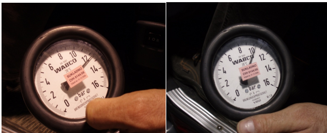
Slika 10.11 Tlak u spremniku drugog kruga (lijevo) i kočnoj instalaciji (desno)
