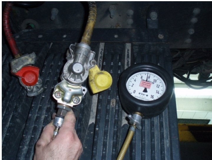
Slika 10.21 Porast tlaka u komandnom vodu priključnog vozila pokretanjem pomoćne kočnice vučnog vozila
