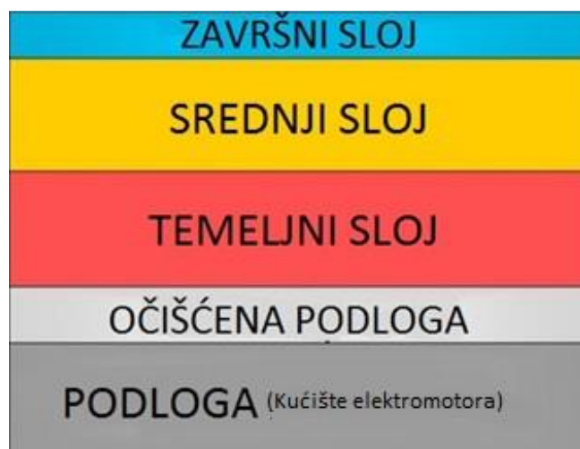
Slika 5. Slojevi boje na predmetu obrade
