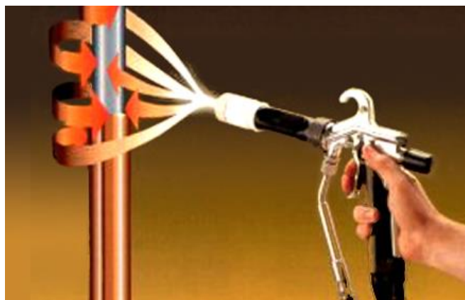
Slika 18. Način primanja boje na obradak
