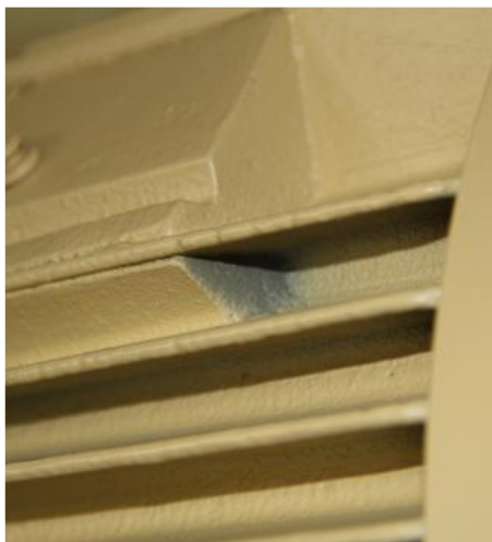
Slika 6. Neobojena mjesta na kućištu elektromotora
