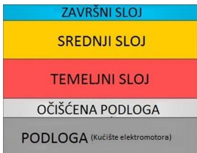
Slika 5. Slojevi boje na predmetu obrade
