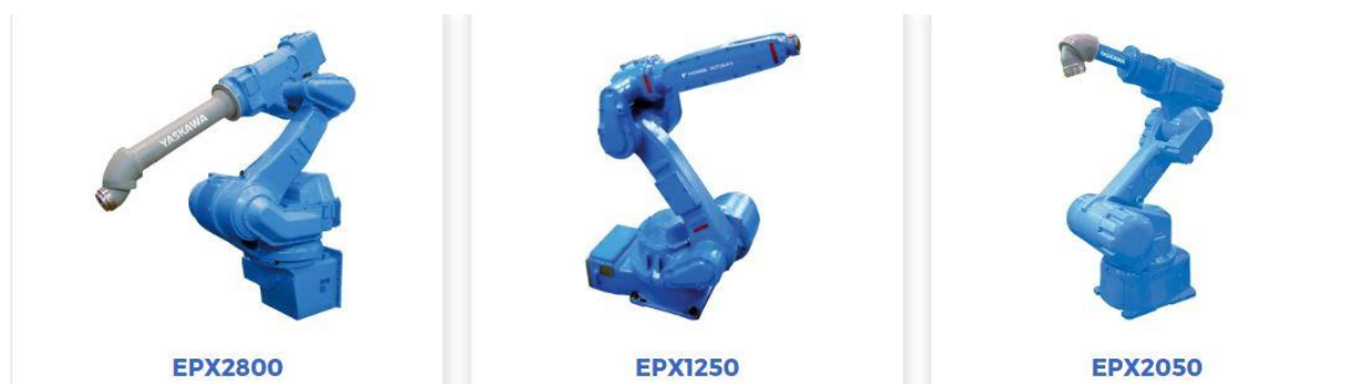
Slika 35. Ponuda robota za proces bojenja tvrtke Yaskawa
