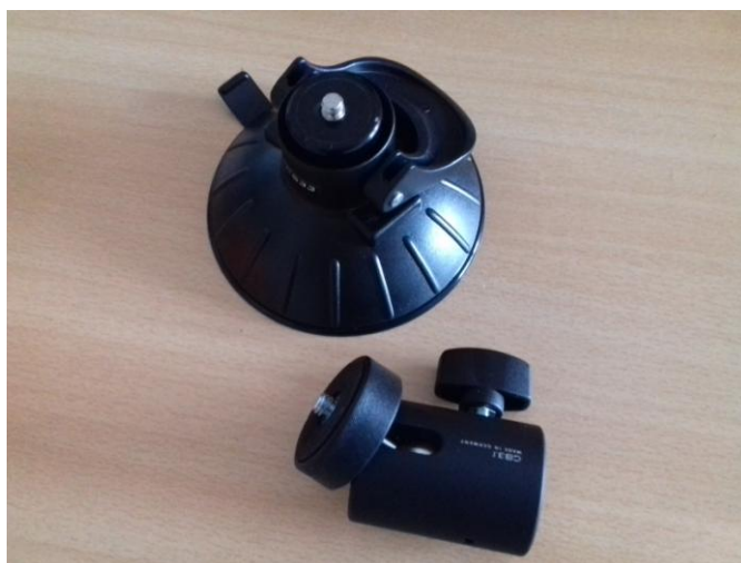
Slika 30. Vakuumski držač uređaja DM01
