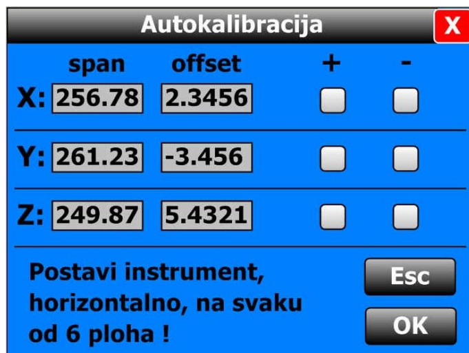
Slika 24. Autokalibracija uređaja DM01
