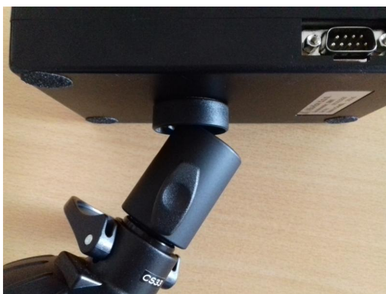
Slika 31. Spoj vakuumskog držača i uređaja
