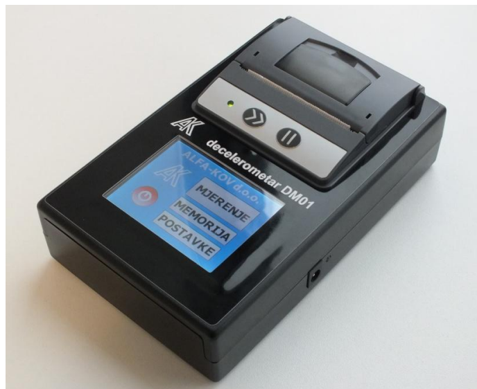
Slika 10. Izgled uređaja DM01
