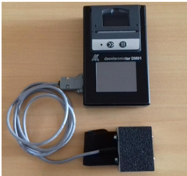
Slika 32. Uređaj DM01 s priklučenim dinamometrom
