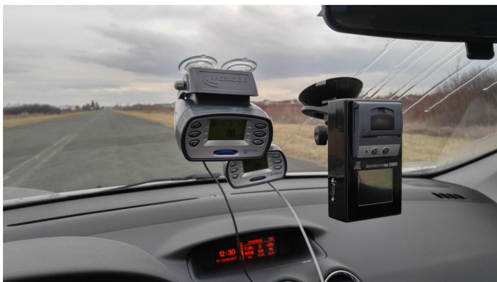
Slika 37. Postavljanje uređaja unutar ispitnog vozila
