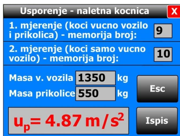
Slika 18. Izračun usporenja prikolice kočene naletnom kočnicom
