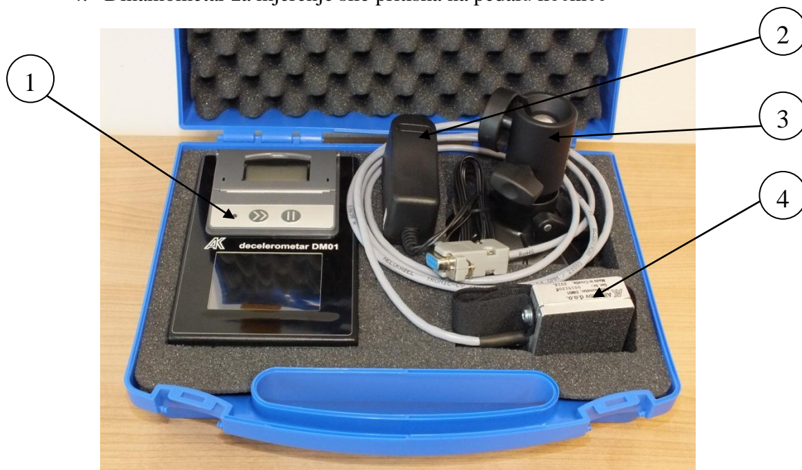
Slika 9. Uređaj za mjerenje usporenja vozila DM01 sa standardnim priborom
