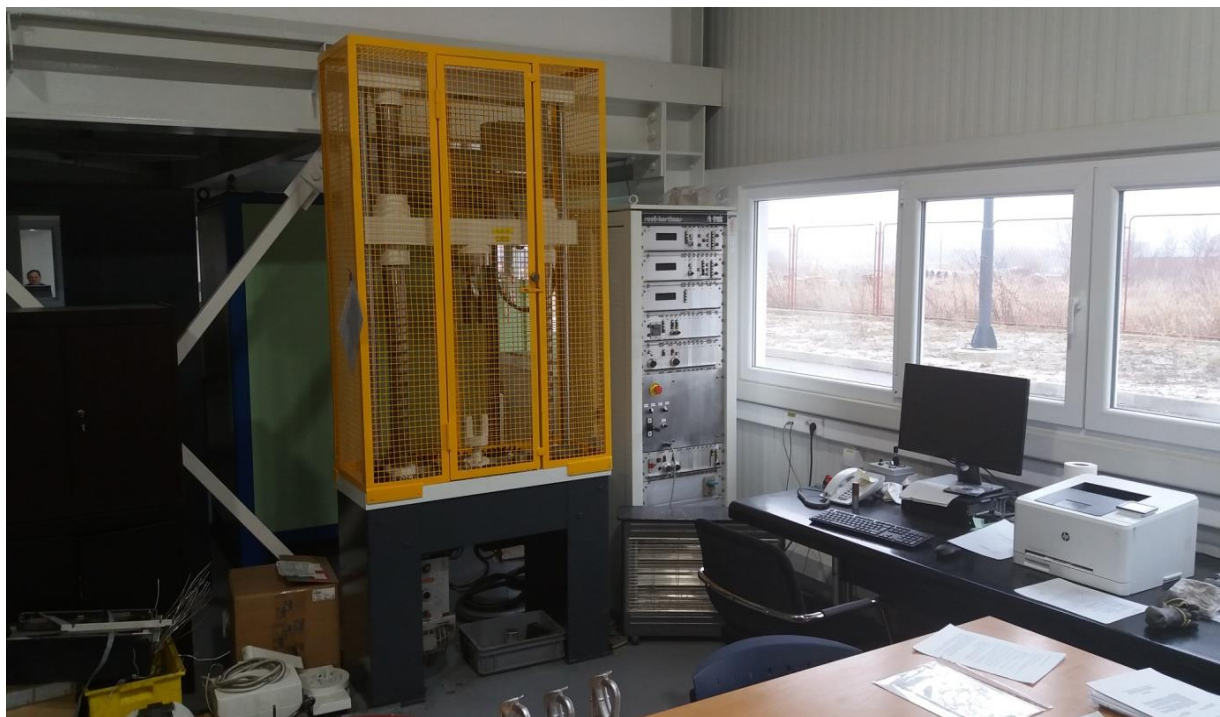
Slika 5. Statička kidalica i upravljačka jedinica
