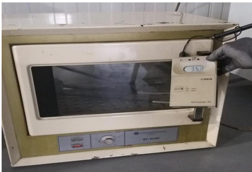
Slika 25. Komora za zagrijavanje uzoraka
