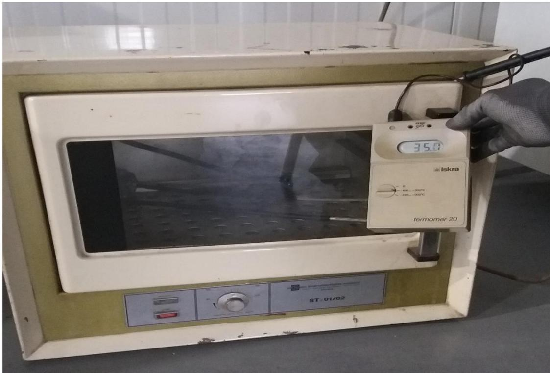
Slika 7. Komora za zagrijavanje uzoraka
