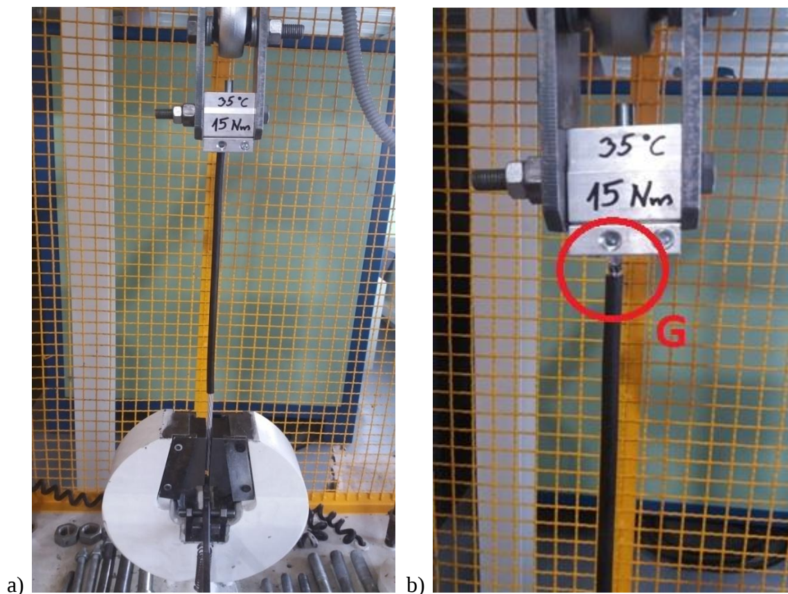
Slika 31. Ispitivanje uzorka na kidalici: a) uzorak prije ispitivanja, b) uzorak nakon ispitivanja i izvlačenja vodiča iz stezaljke
