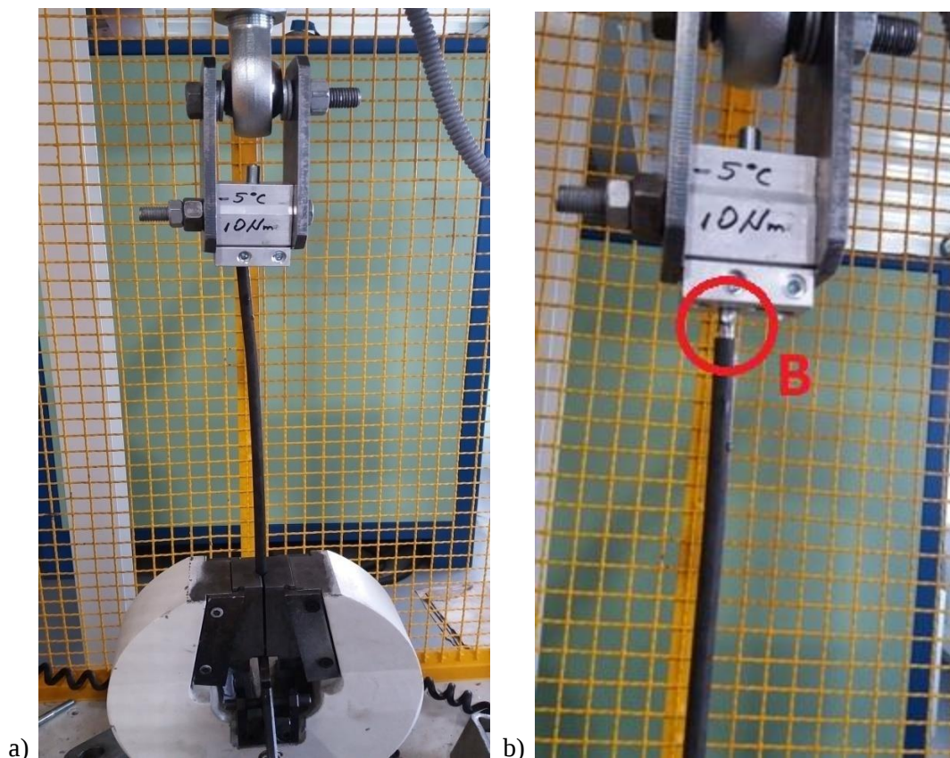
Slika 21. Ispitivanje uzorka na kidalici: a) uzorak prije ispitivanja, b) uzorak nakon ispitivanja
