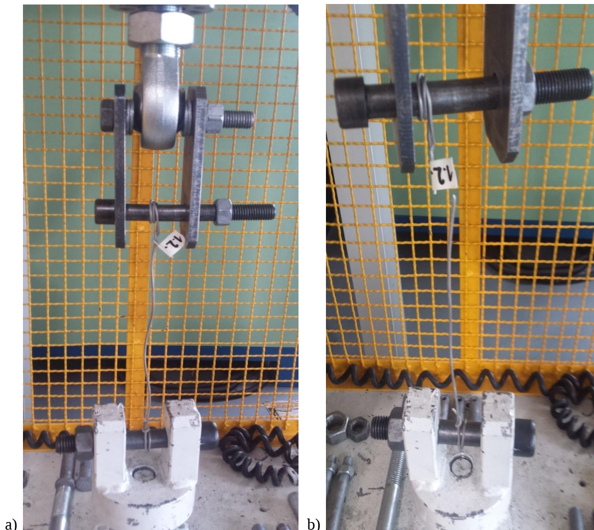
Slika 10. Ispitivanje uzorka na kidalici: a) uzorak 1.2 prije ispitivanja, b) uzorak 1.2 nakon ispitivanja
