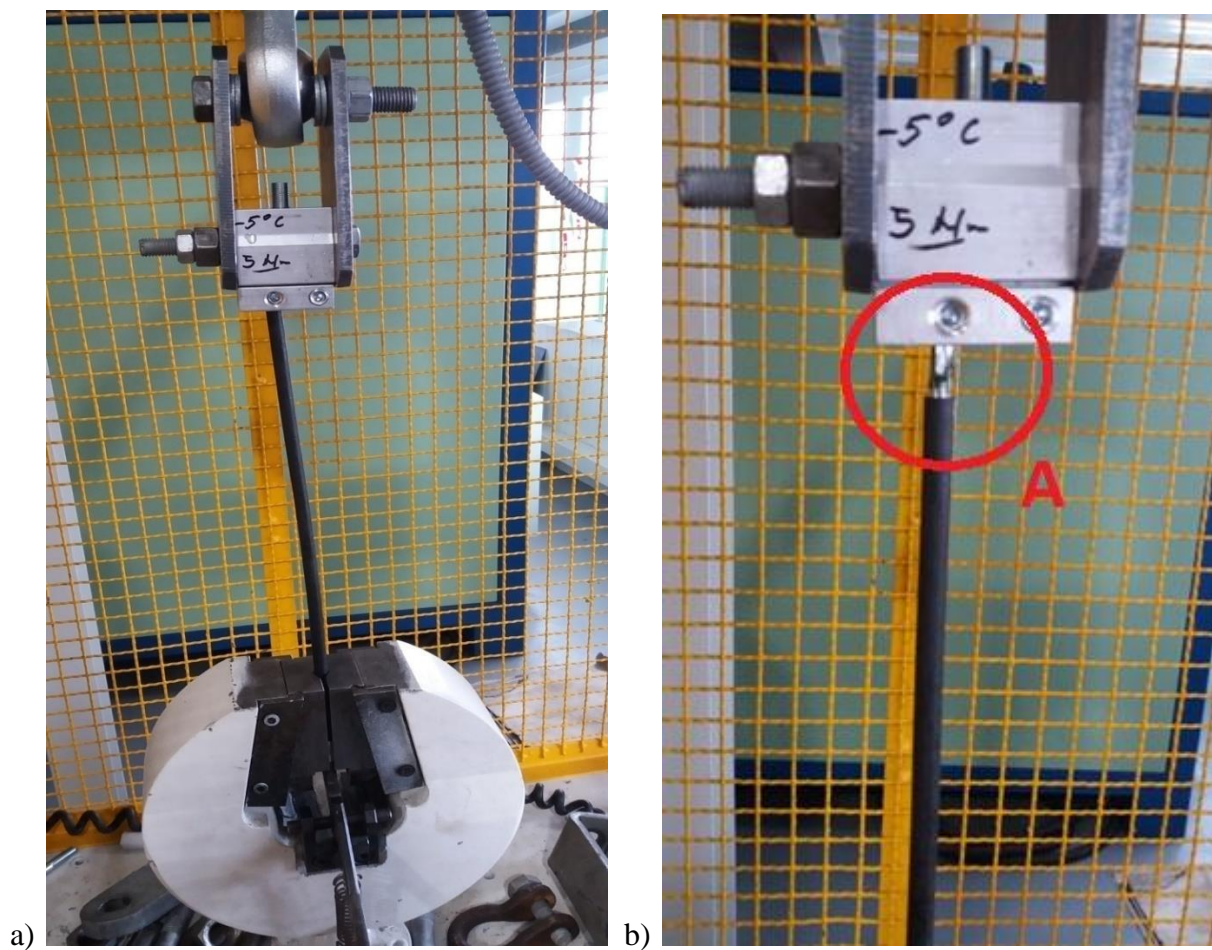
Slika 19. Ispitivanje uzorka na kidalici: a) uzorak prije ispitivanja, b) uzorak nakon ispitivanja
