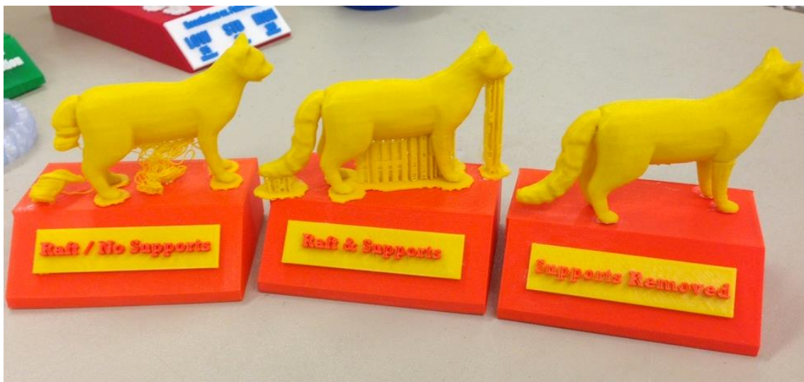
Slika 9. Prikaz predmeta s i bez potporne strukture [24]
