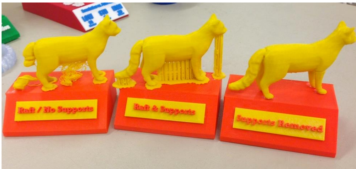
Slika 9. Prikaz predmeta s i bez potporne strukture [24]
