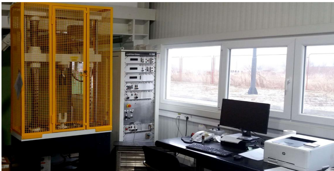
Slika 5. Statička kidalica s pripadajućom upravljačkom jedinicom
