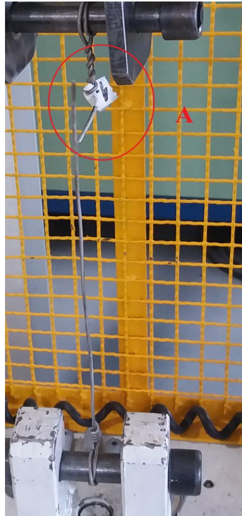
Slika 9. Ispitivanje na kidalici: a) uzorak prije ispitivanja, b) uzorak poslije ispitivanja
