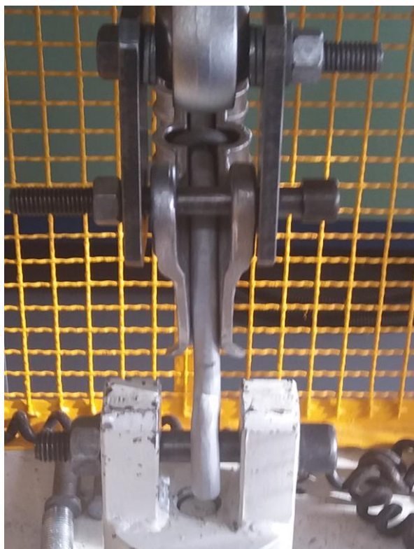
Slika 37. Ispitivanje uzorka na kidalici
