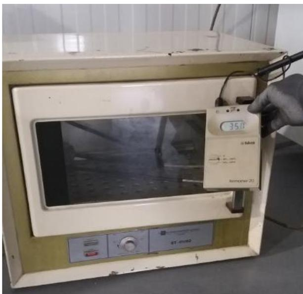
**Slika 6. Komora za zagrijavanje ispitnih uzoraka**
