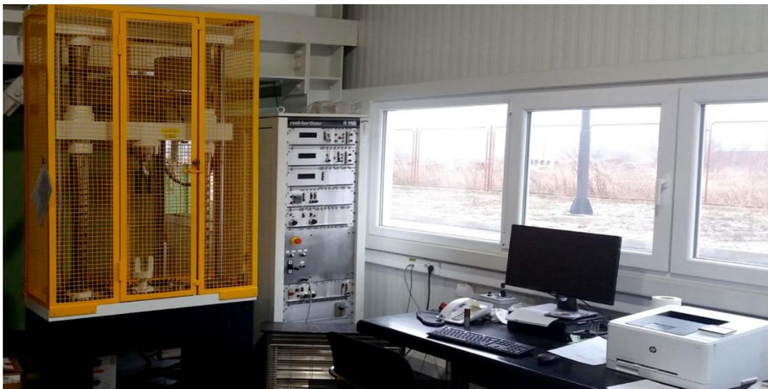
Slika 5. Statička kidalica s pripadajućom upravljačkom jedinicom
