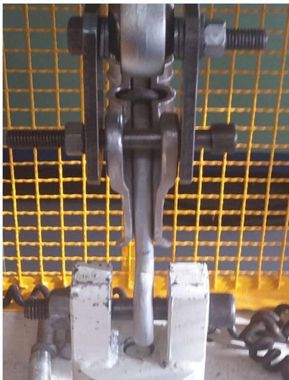
**Slika 37. Ispitivanje uzorka na kidalici**
