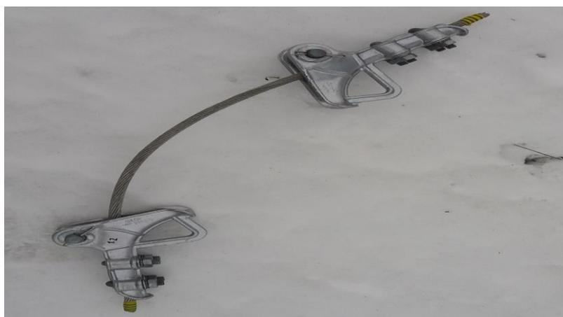
**Slika 23. Uzorak za ispitivanje sile izvlačenja vodiča**
