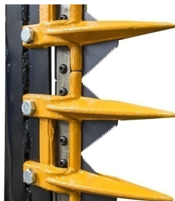
Slika 7. Način pričvršćivanja noževa
