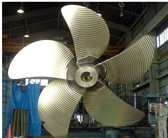
Slika 2. Vijak s konstantnim usponom
