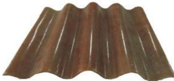
Slika 4.4. Ploča za pokrivanje krovova izrađena od kompozita s bambusovim vlaknima [11]
