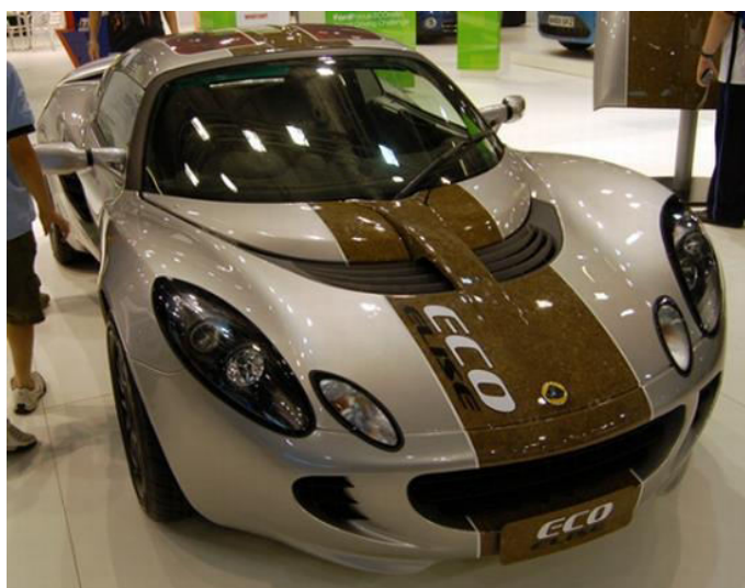
Slika 4.21. Automobil Lotus-Eco-elise napravljen od kompozita konoplje [31]
