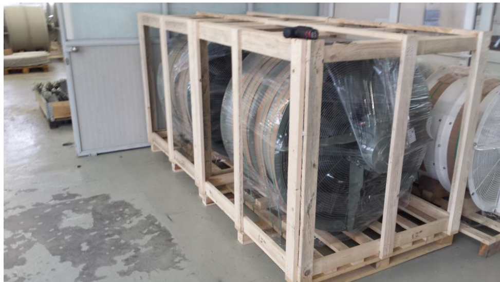
Slika 23. Slaganje i pakiranje ventilatora za isporuku
