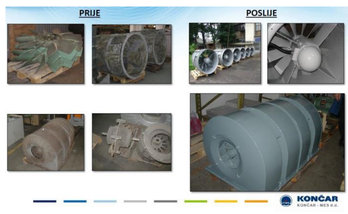
Slika 14. Stanje ventilatora prije i nakon servisa[20]
