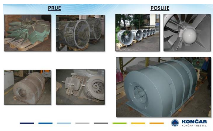
Slika 14. Stanje ventilatora prije i nakon servisa[20]
