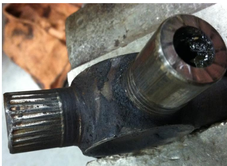
Slika 21. Utiskivanje valjnih tijela u rukavac [17]
