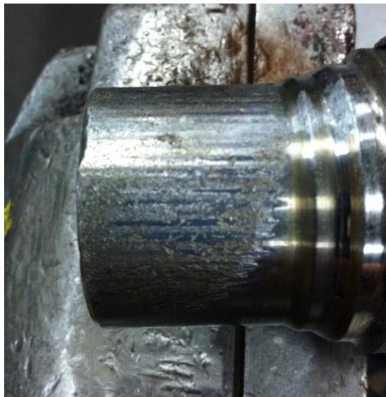
Slika 23. Oštećenje zbog prisustva vode i prljavštine [17]
