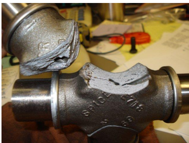
Slika 19. Lom uslijed preopterećenja [17]
