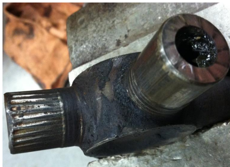
Slika 21. Utiskivanje valjnih tijela u rukavac [17]
