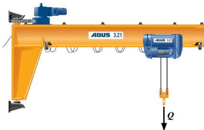
Slika 1. Prikaz savijanja grede na primjeru realne konstrukcije
