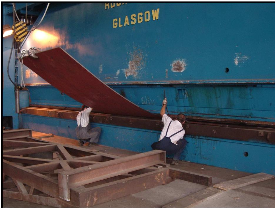
**Slika 11.** Velika preša za savijanje limova
