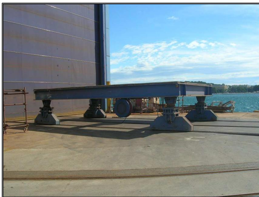
**Slika 16.** Tračni parterni transporter protočne radionice za antikorozivnu zaštitu
