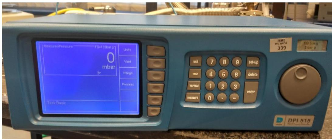
**Slika 4.4 Pretvornik tlaka DPI 515 u načinu mjerjenja tlaka**
