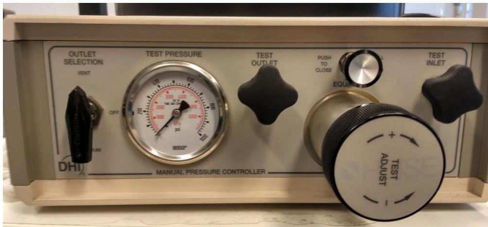
**Slika 3.2 Ručni regulator tlaka MPC1**
