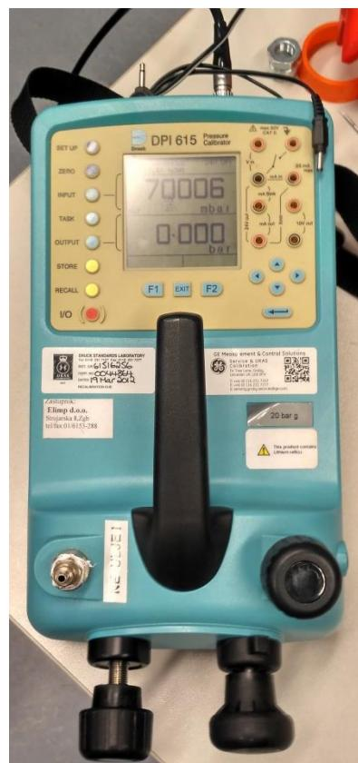
**Slika 6.1 Kalibrator tlaka DPI 615 u načinu mjerjenja tlaka**
