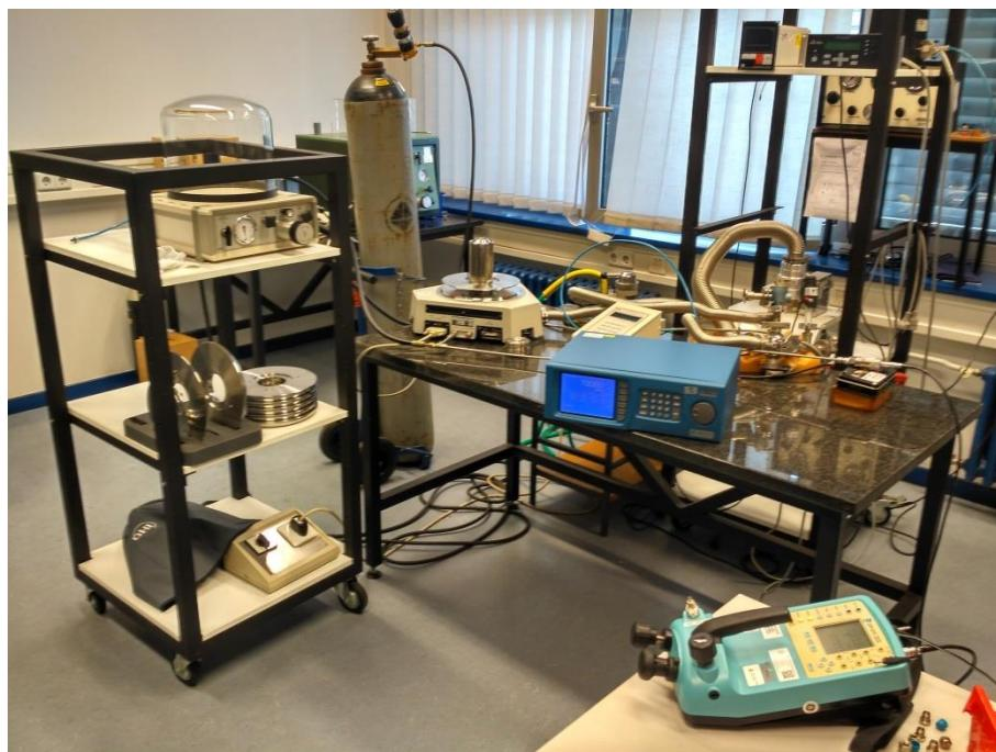
**Slika 6.3 Linija za umjeravanje kalibratora tlaka DPI 615**
