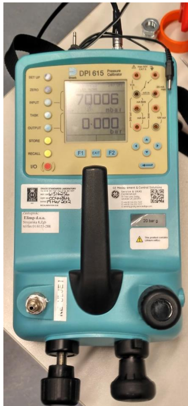
Slika 6.1 Kalibrator tlaka DPI 615 u načinu mjerenja tlaka
