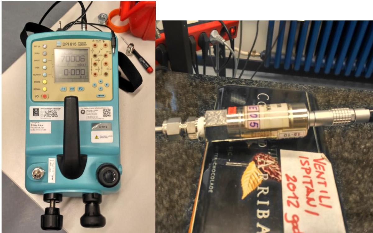
Slika 12. Pokazivač DPI 615 sa pretvornikom tlaka
