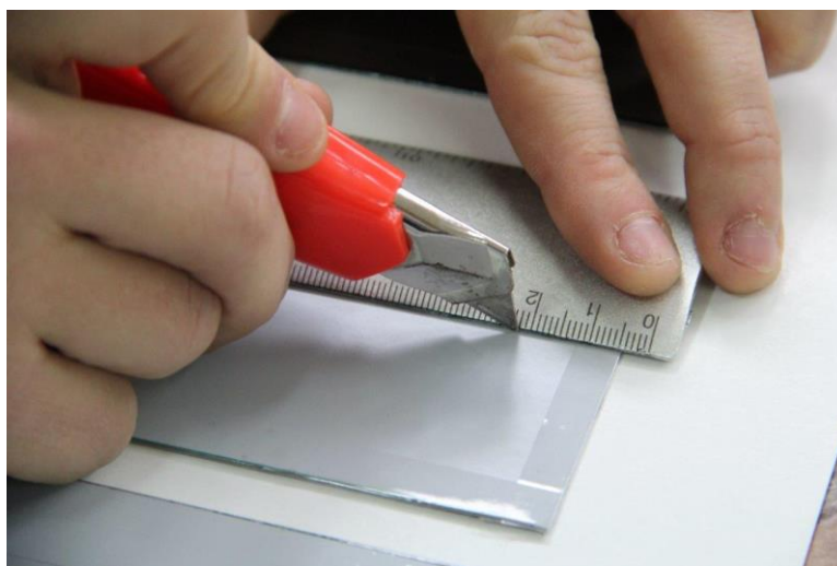
Slika 25: Zarezivanja ureza na uzorcima prije stavljanja u vlažnu komoru
