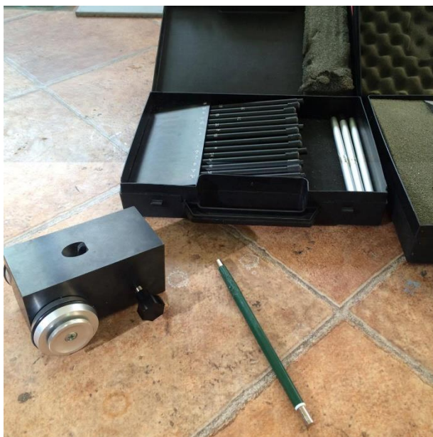
Slika 19: Set za mjerenje tvrdoće premaza
