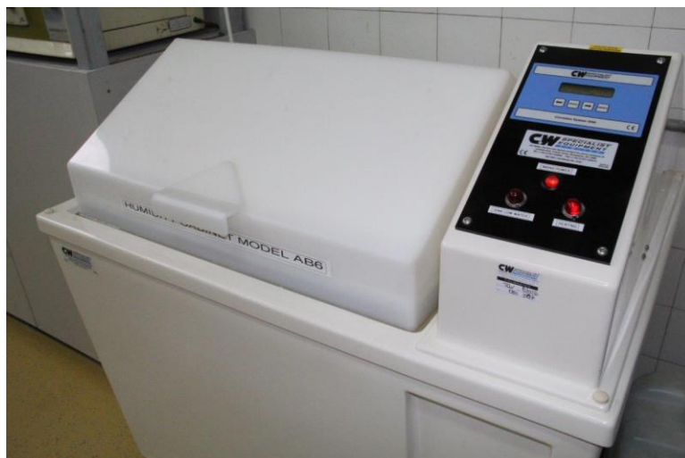
Slika 24: Vlažna komora C&W, Model AB6
