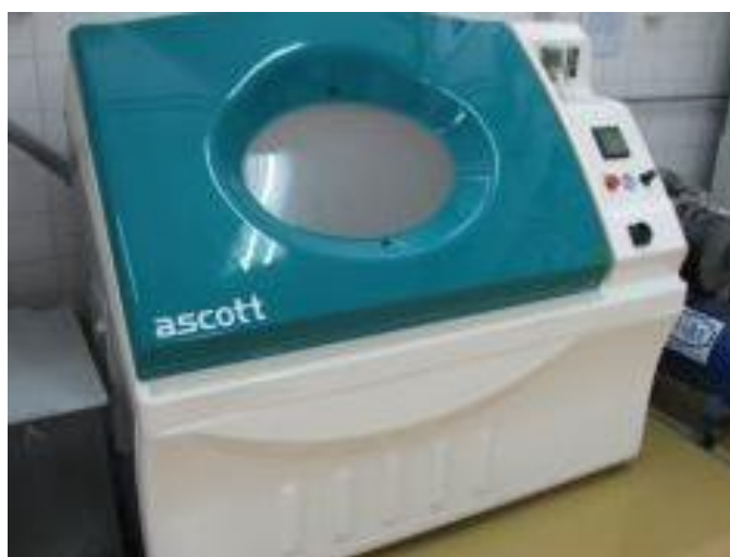
Slika 20: Slana komora Ascott S450
