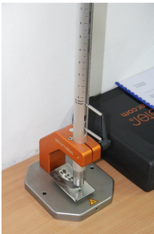
Slika 17: Ispitivanje otpornosti premaza na udar
