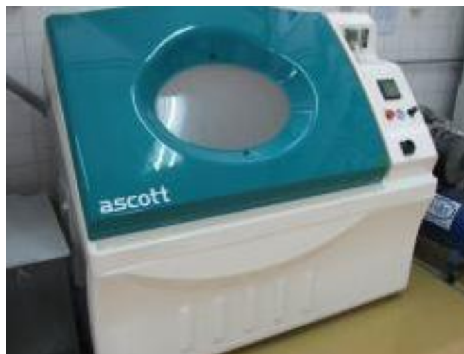
Slika 20: Slana komora Ascott S450
