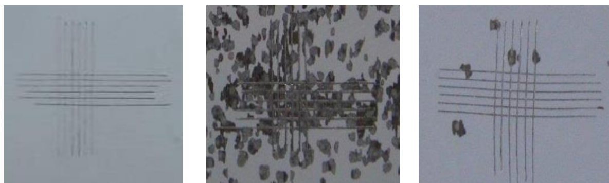
Slika 32: Uzorci premazani istim premazom, 395 sa VCI inhibitorom, ispitani na prionjivost Cross-cut metodom
