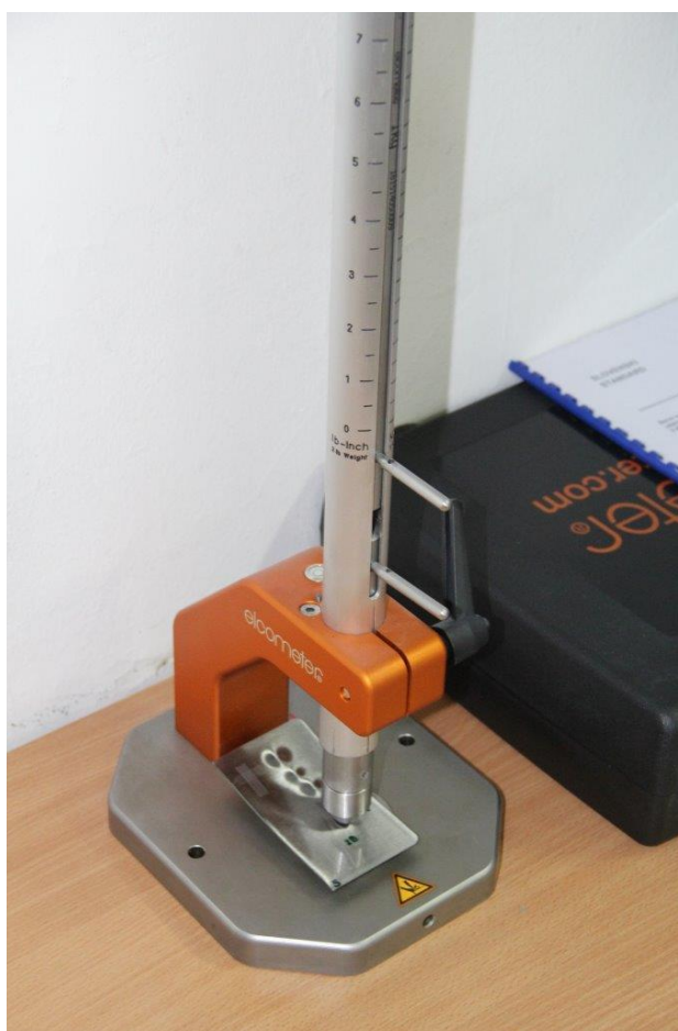
Slika 17: Ispitivanje otpornosti premaza na udar
