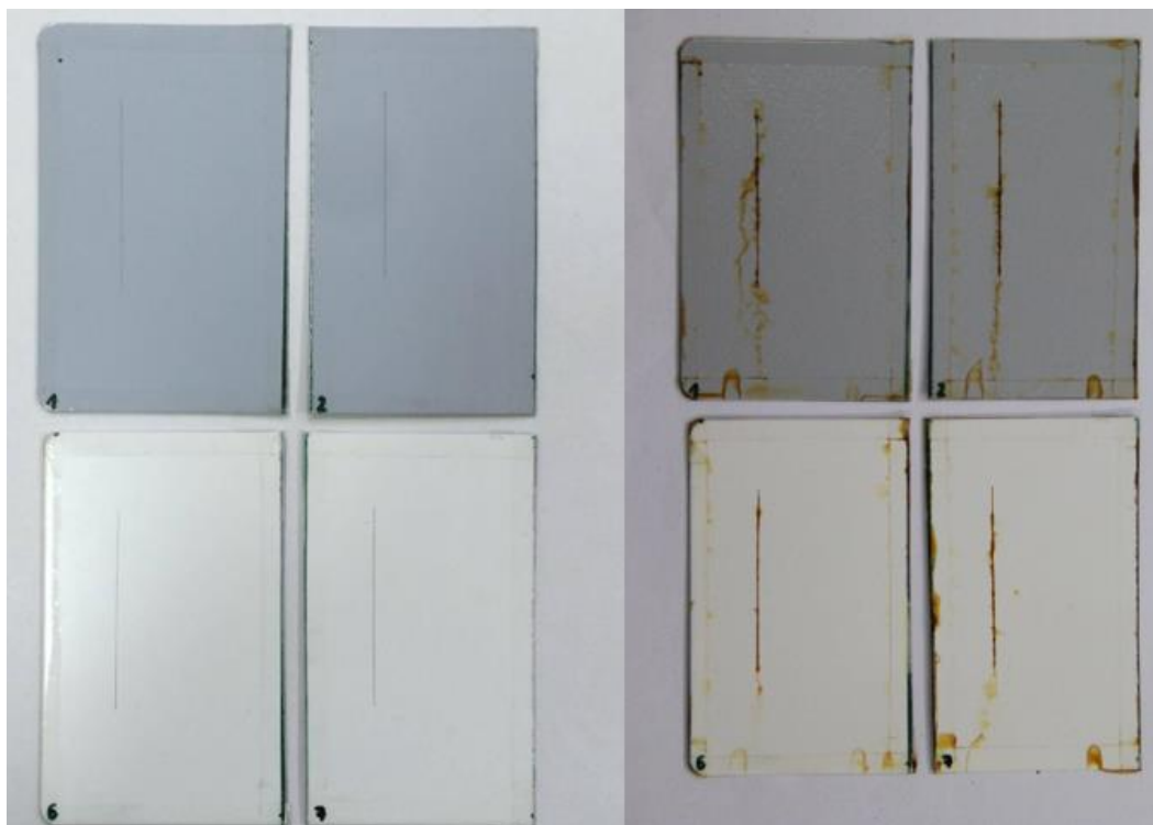
Slika 21: Uzorci 1 i 2 zaštićeni premazom 395 sa VCI inhibitorom te uzorci 6 i 7 zaštićeni premazom 395 bez VCI inhibitora prije (lijevo) i poslije (desno) ispitivanja u slanoj komori
