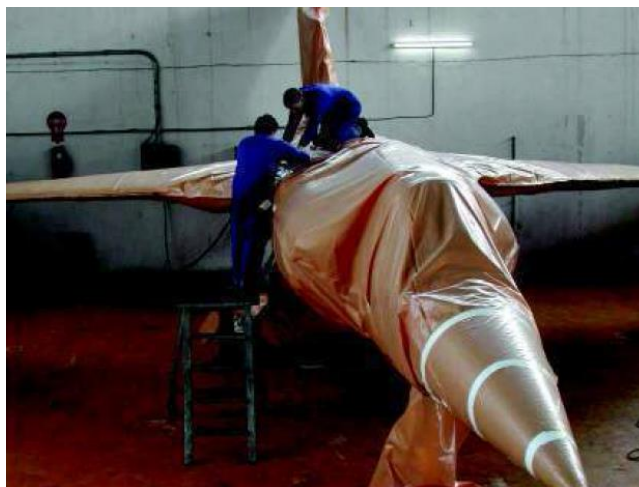
Slika 7: Primjer zaštite borbenog zrakoplova primjenom folije s VCI inhibitorom [1]
