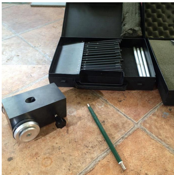
Slika 19: Set za mjerenje tvrdoće premaza
