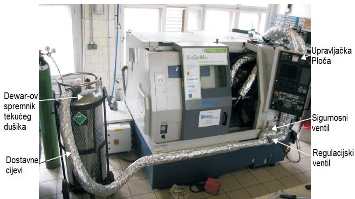
Slika 32. Postavke opreme za kriogenu obradu [9]
