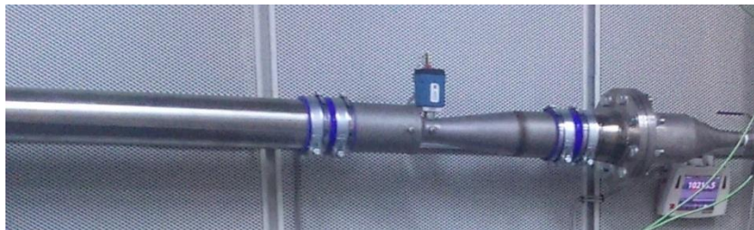
Slika 11 Anemometar s ugrijanom žicom, Model 2017L-V.
