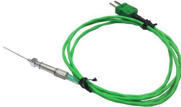
Slika 10 Električni termopar tip K.
