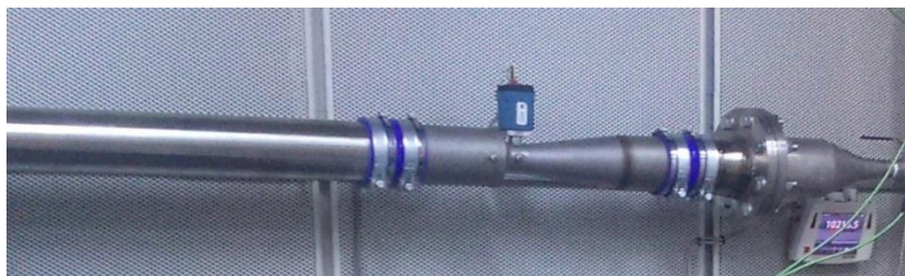
Slika 11 Anemometar s ugrijanom žicom, Model 2017L-V.
