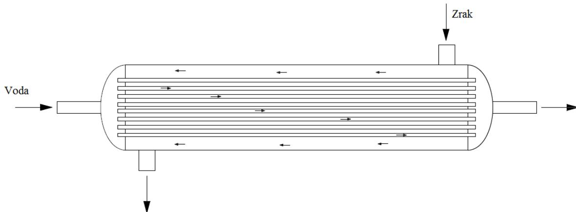
**Slika 3.1. Protusmjerni Shell and Tube izmjenjivač topline**
