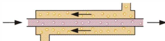
Slika 1.3. Protusmjerni tip rekuperatora; [4]
