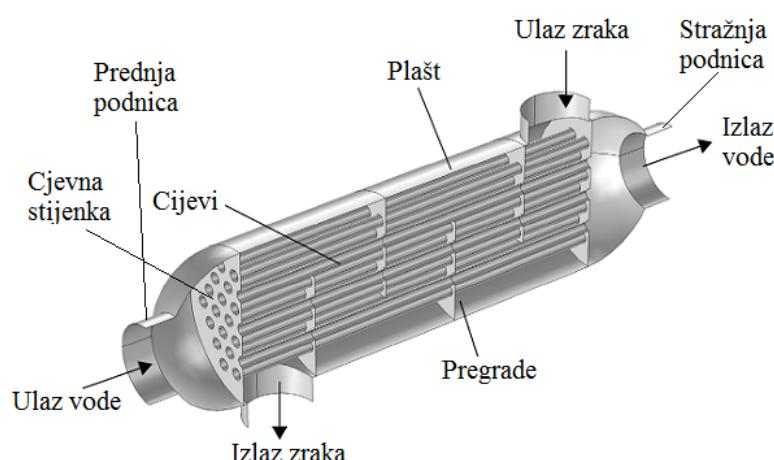
Slika 1.7. Presjek Shell and Tube izmjenjivača topline; [8]
