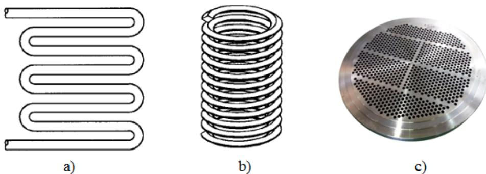
Slika 1.8. a) Zmijoliki oblik cijevi; b) Spiralni oblik cijevi; c) Cjevna stijenka; [6]
