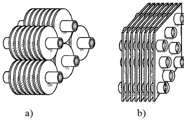
**Slika 1.6. Osnovne strukture lamelnih izmjenjivača topline; [7]**
