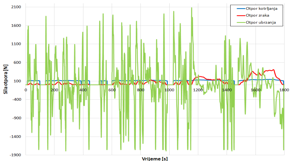
Slika 4.1. Sile pojedinih otpora vožnje električnog vozila
