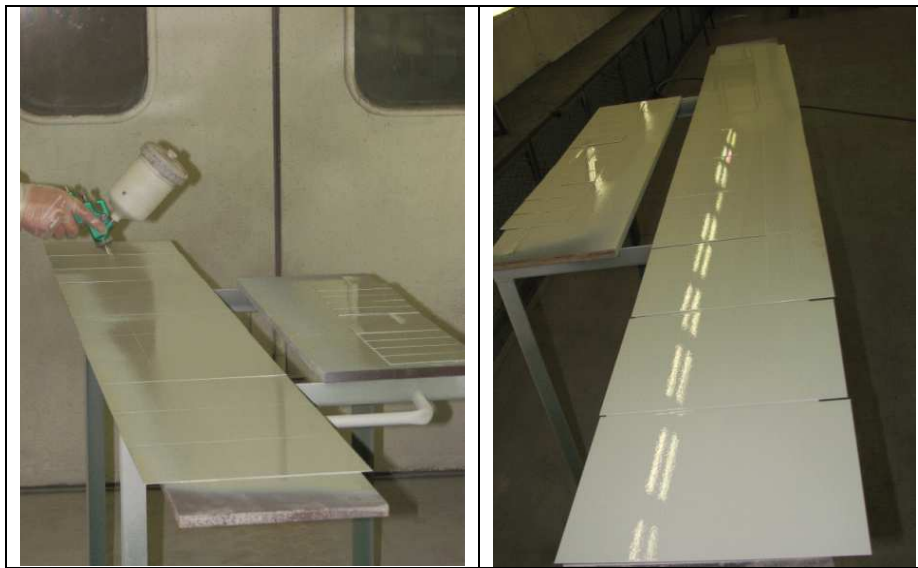
Slika 38. Nanošenje međuslojnog premaza [17]
