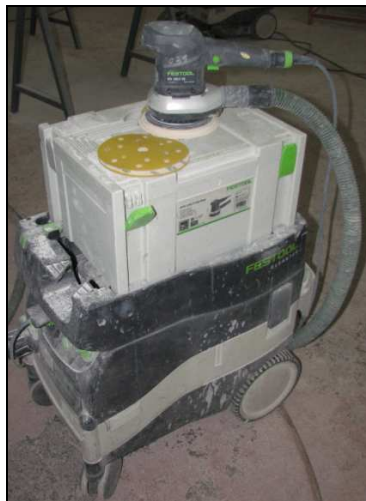
Slika 35. Ručna vibraciona brusilica [17]
