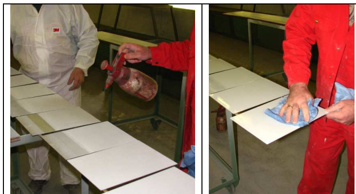
Slika 42. Čišćenje uzoraka sredstvom za odstranjivanje prašine [17]
