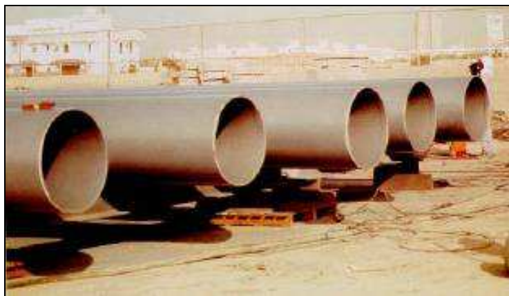
Slika 34. Cjevovod za plin zaštićen hibridnim premaznim sistemom [12]
