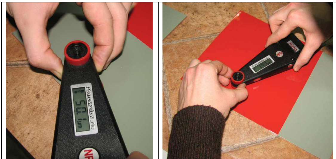
Slika 46. Mjerenje debljine prevlake po slojevima [17]
