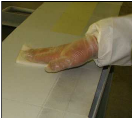
Slika 43. Odstranjivanje prašine Würth Staubbinderuch krpom [17]
