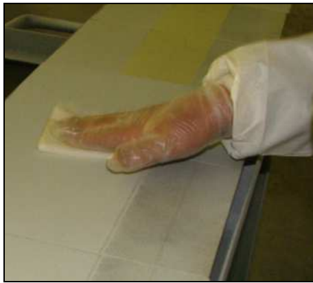
Slika 43. Odstranjivanje prašine Würth Staubbinderuch krpom [17]
