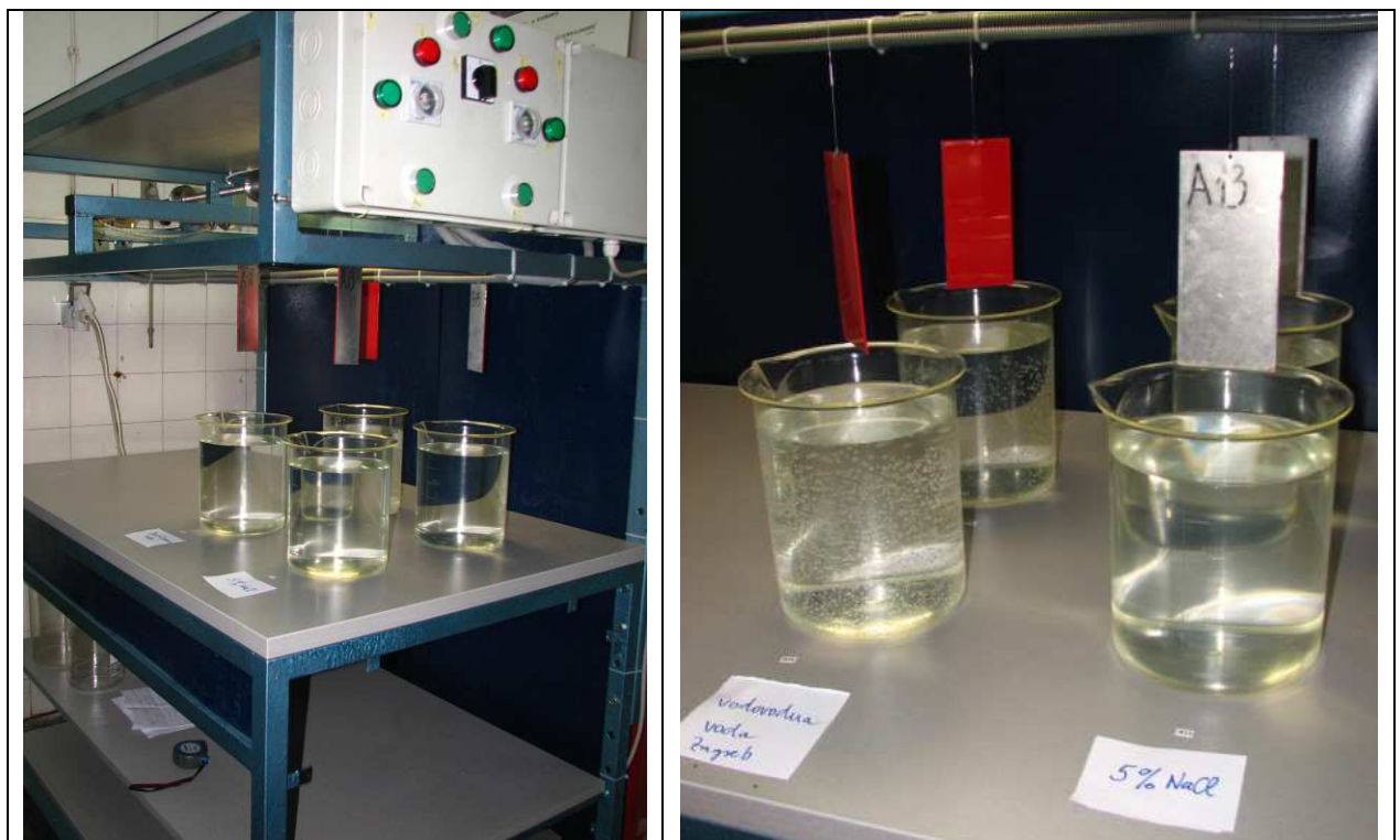
Slika 53. Uređaj za ispitivanje uranjanjem [17]
