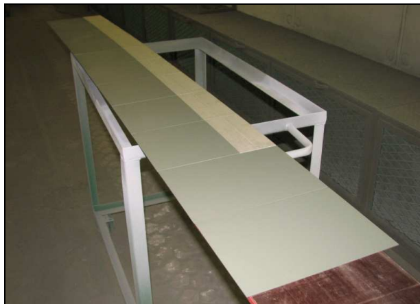
Slika 36. Uzorci prevučeni temeljnim premazom [17]
