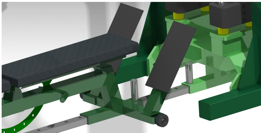
Slika 87. Sustav za vođenje sjedala sprave pogled 1
