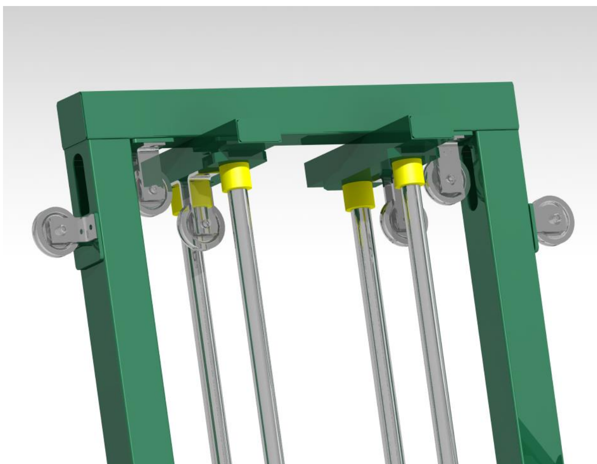
Slika 86. Gornji dio sustava za vođenje utega
