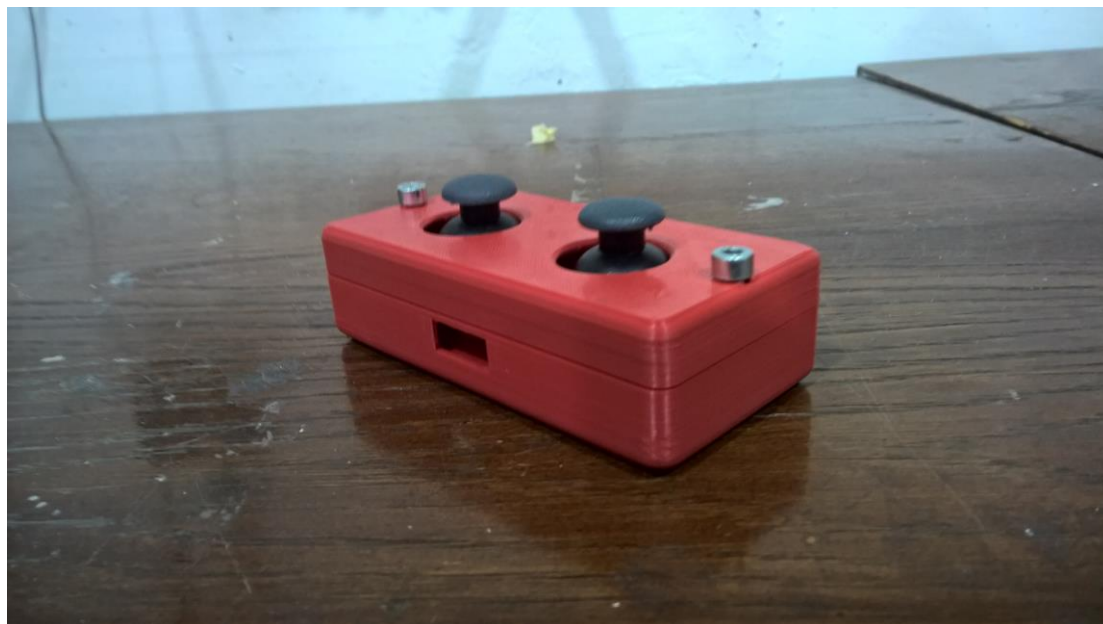
Slika 33. 3D printana upravljačka palica
