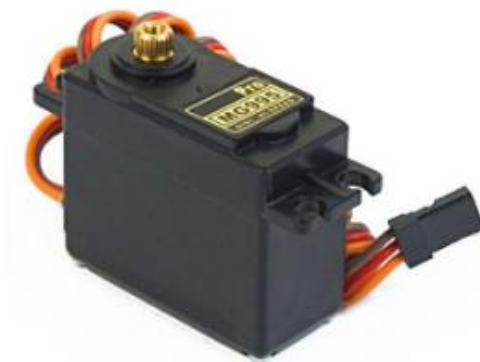
Slika 12. Servo motor MG995
