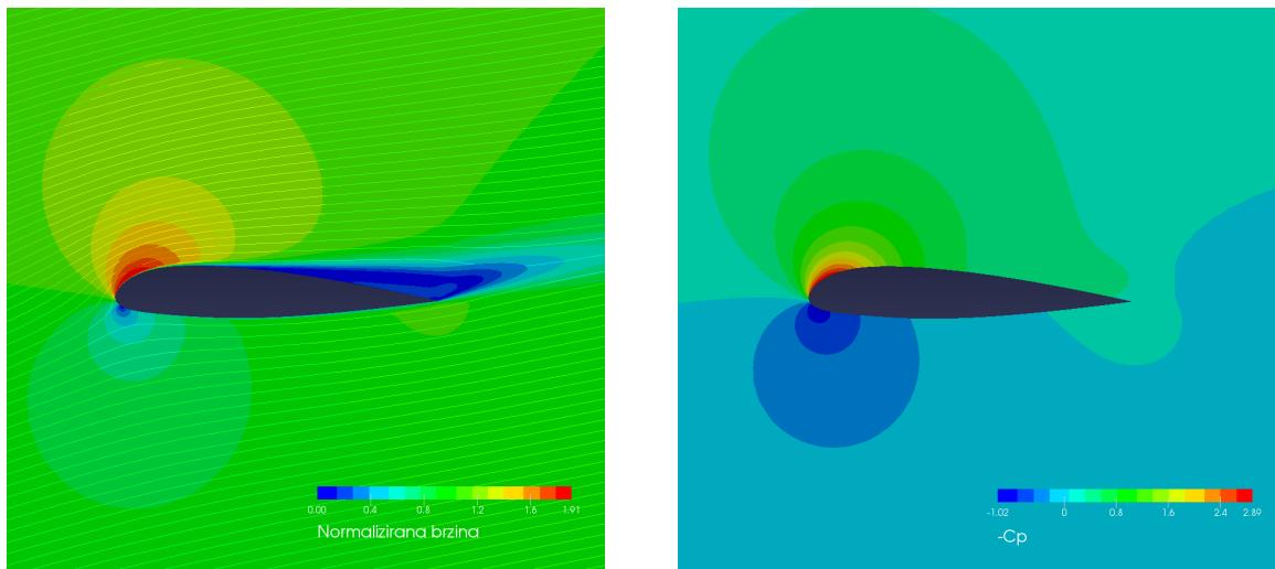
**Slika 13:** Polje brzine i tlaka oko profila dobiveno  $k - \omega$  SST modelom za  $\alpha = 13,3^\circ$ .
