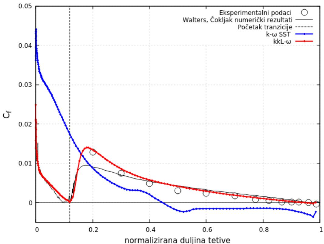
**Slika 17:** Usporedba numeričkih i eksperimentalnih rezultata za  $c_f$  pri  $\alpha = 13,3^\circ$ .
