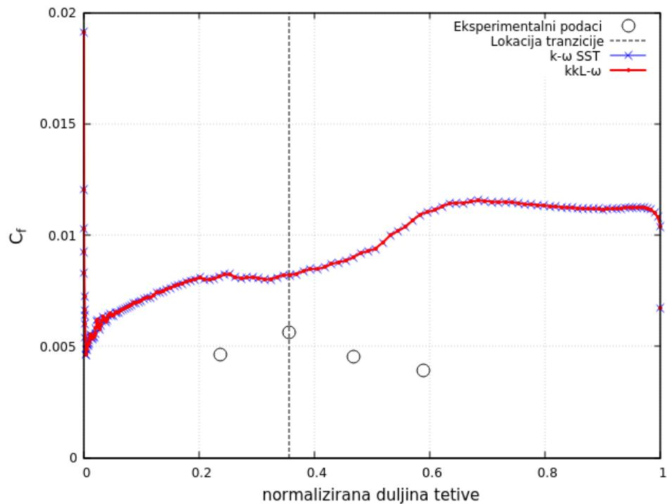
Slika 22: Usporedba numeričkih i eksperimentalnih rezultata za  $c_f$  pri  $\alpha = 4,8^\circ$ .
