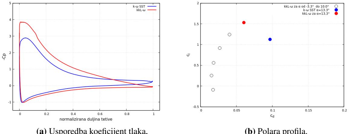
Slika 18: Rezultati  $kkL - \omega$  simulacije za profil.
