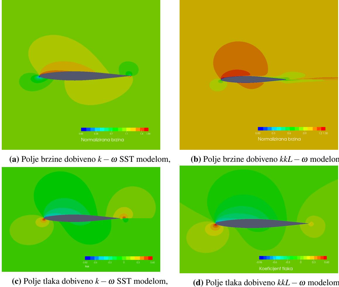
**Slika 20:** Polje brzine i tlaka oko krila za  $\alpha = 4,8^\circ$
