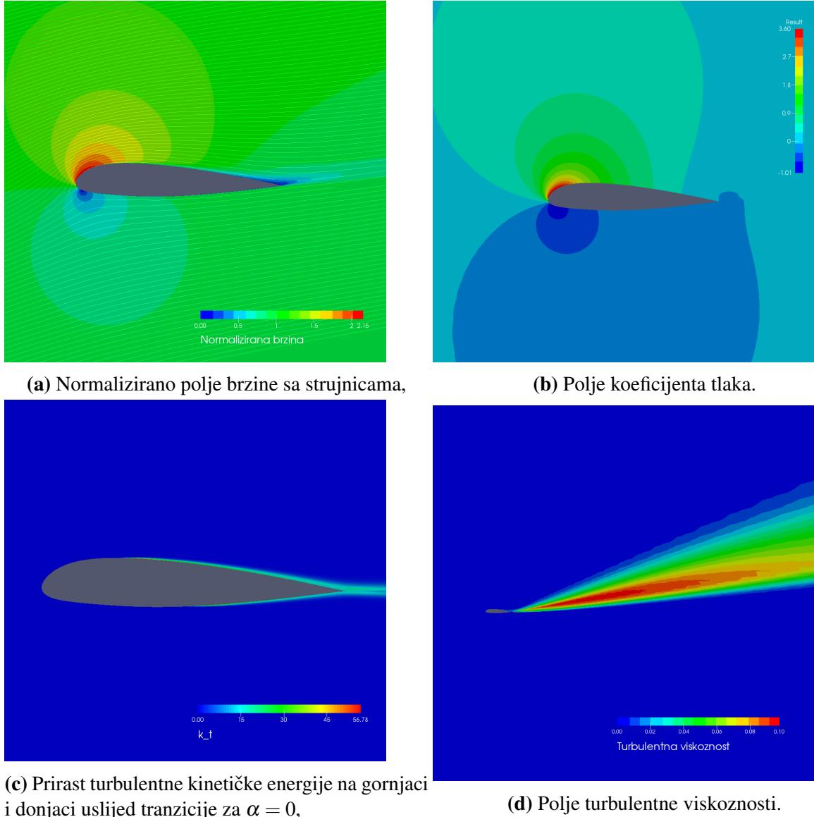
**Slika 15:** Strujanje oko profila s  $kkL - \omega$  modelom turbulencije za  $\alpha = 13,3^\circ$ .
