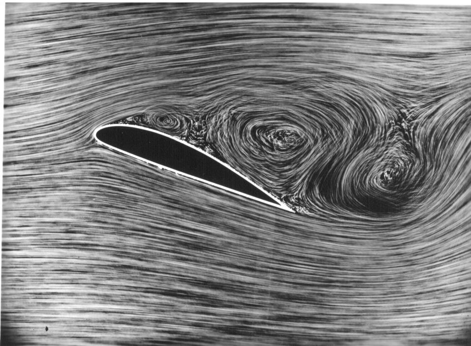
**Slika 4:** Odvanje strujanja pri velikim napadnim kutevima.
