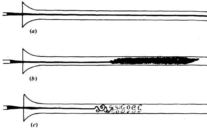
**Slika 1:** Reynoldsovi crteži koji prikazuju stabilno (a), nestabilno (b) i nestabilno strujanje osvjetljeno iskrom (c) (Reynolds, 1887).
