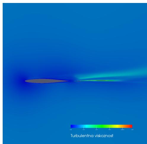
(d) Turbulentna viskoznost dobivena  $kkL - \omega$  modelom,
