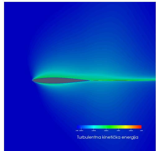
(f) Turbulentna kinetička energija dobivena  $kkL - \omega$  modelom.
