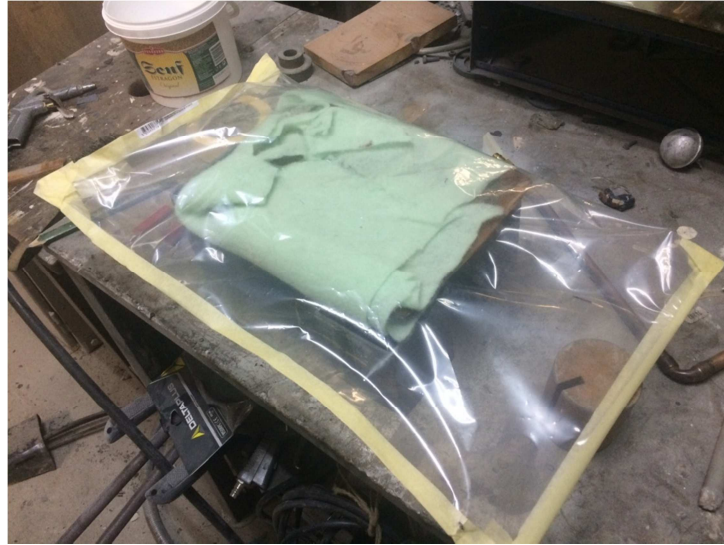
Slika 3.3.5 Pripremanje kalupa za vakuumiranje
