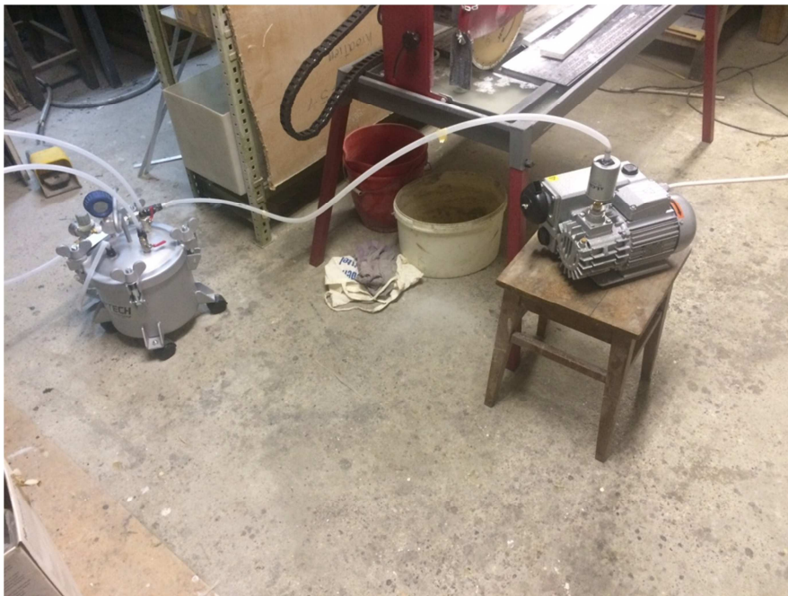
Slika 3.3.6 Uređaj za vakuumiranje
