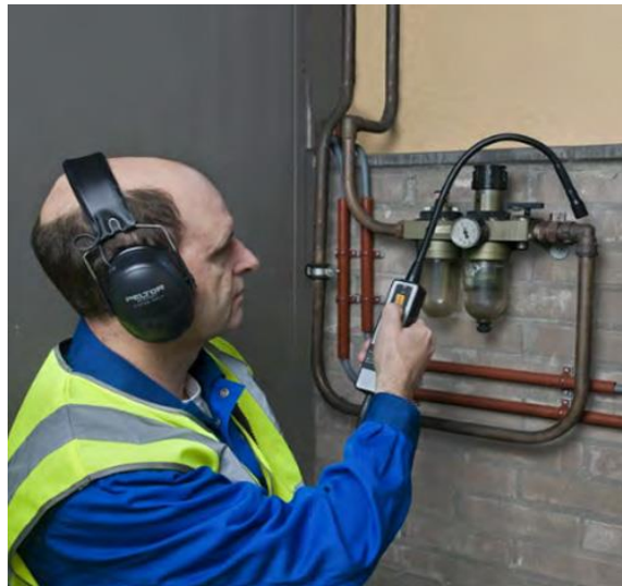
Slika 10. Metoda preslušavanja ultrazvuka [6]
