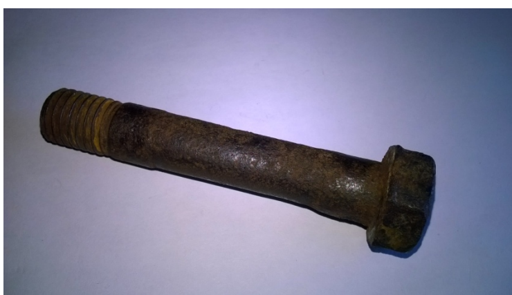
Slika 39. Korišteni vijak koji povezuje nož malčera sa osovinom
