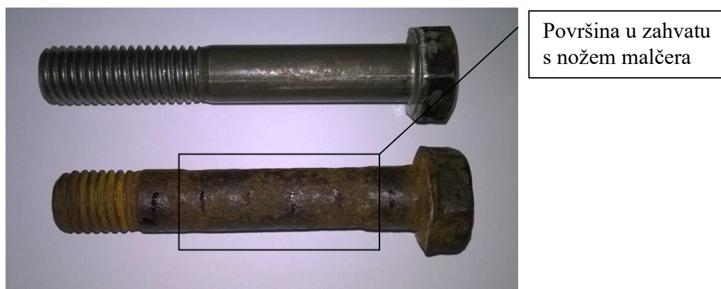
Slika 40. Usporedba korištenog i nekorištenog vijka
