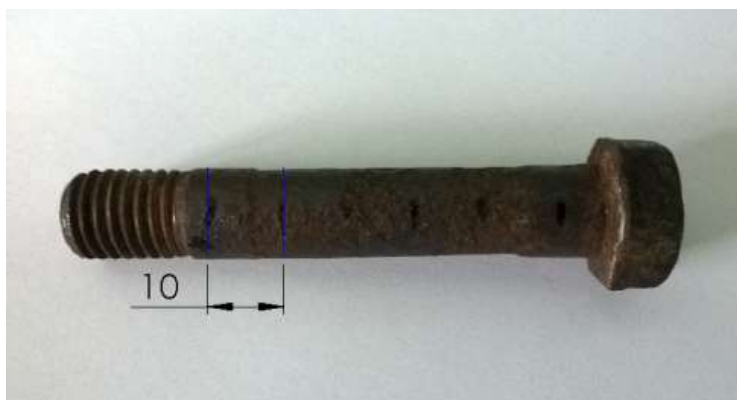
Slika 41. Linije za mjerenje promjera korištenog vijka
