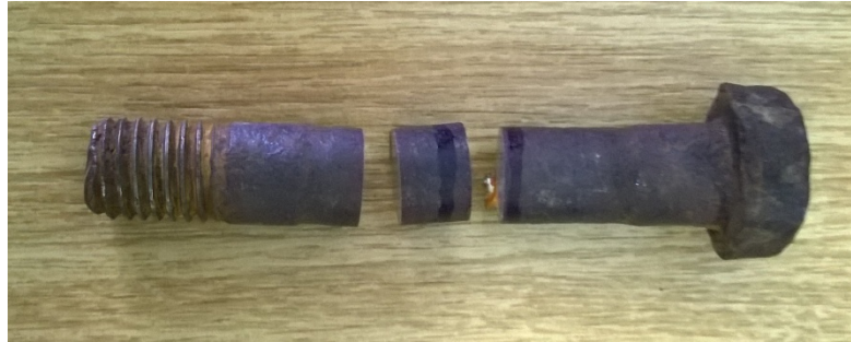
Slika 42. Odrezani uzorak vijka za metalografsku analizu
