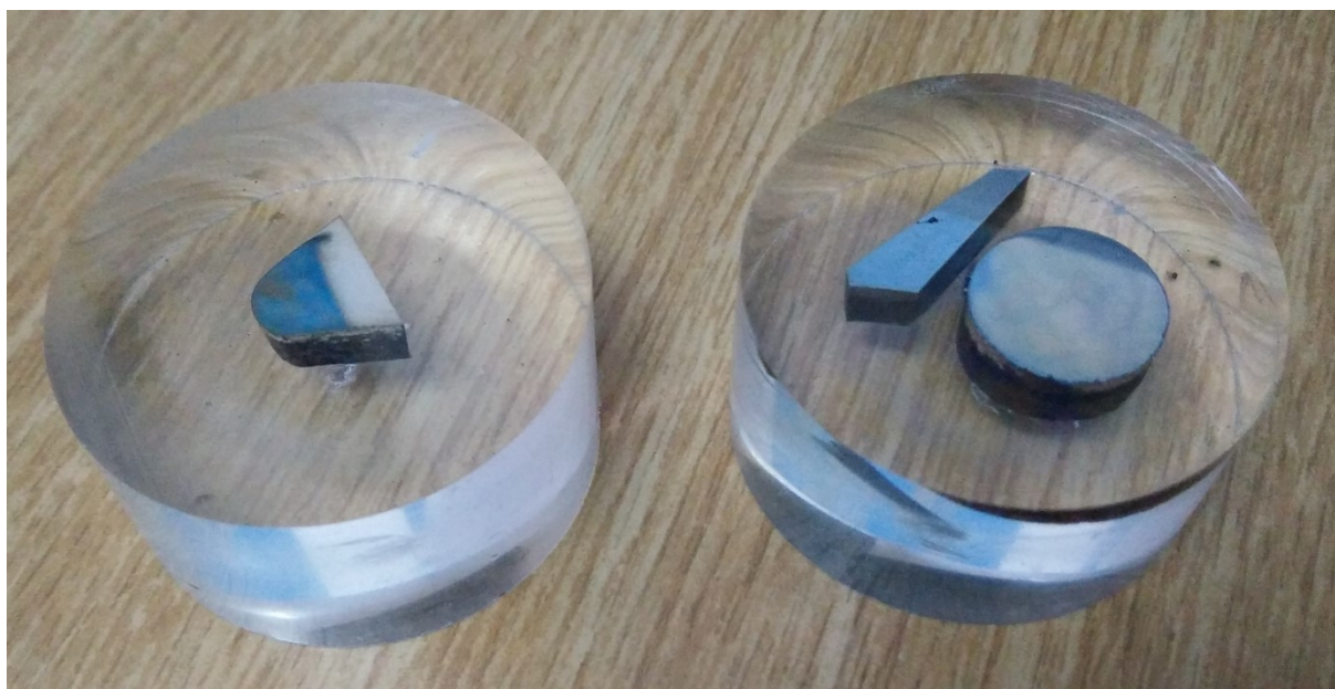
Slika 14. Polirani uzorci u polimernom kalupu
