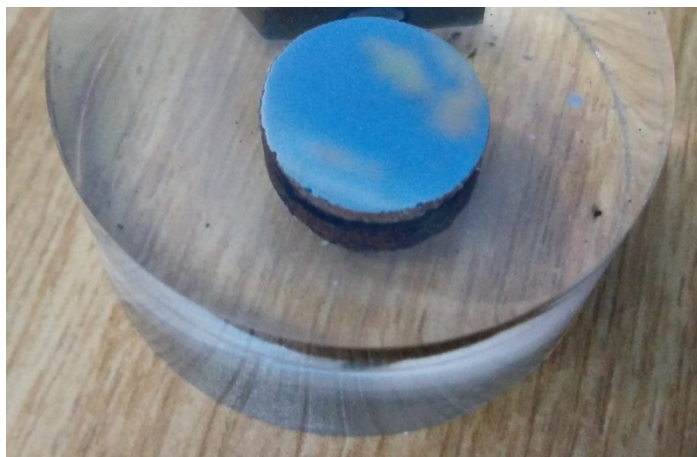
Slika 43. Uzorak vijka u polimernom kalupu
