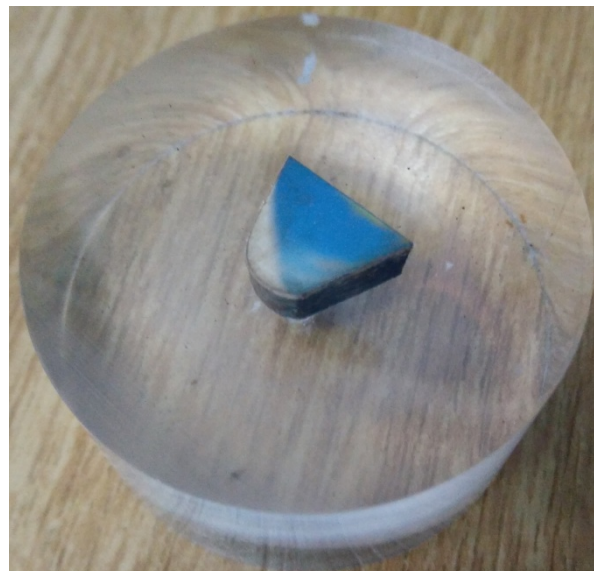
Slika 36. Uzorak noža malčera u kalupu
