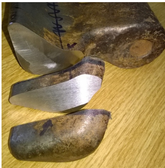
Slika 35. Odrezani uzorak noža malčera za analizu
