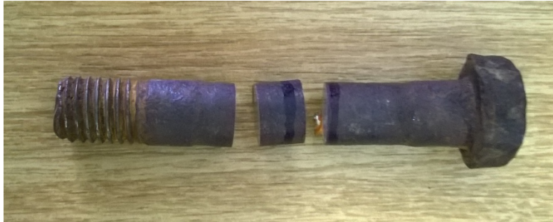
Slika 42. Odrezani uzorak vijka za metalografsku analizu
