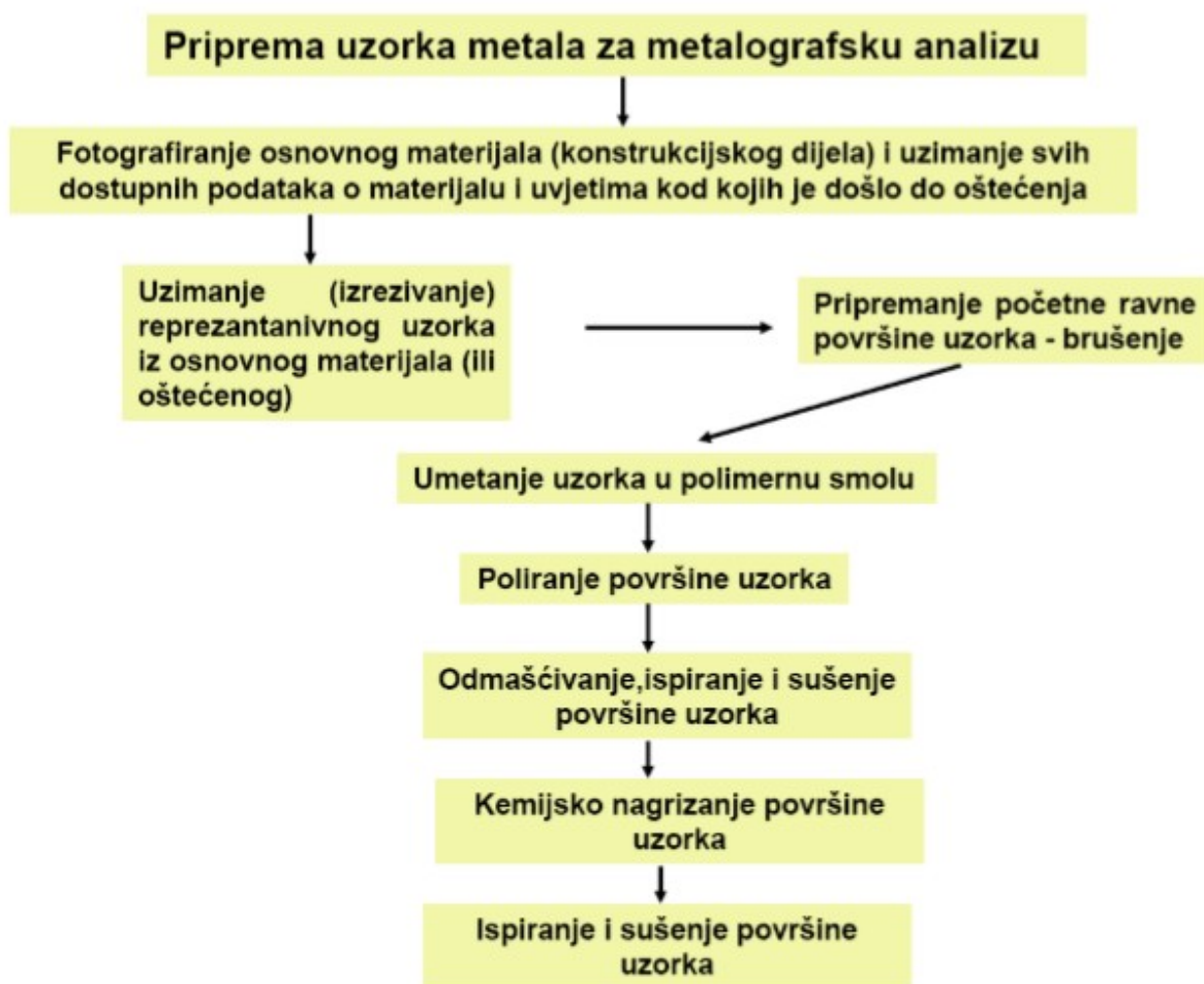
Slika 13. Priprema uzorka za metalografsku analizu [14]
