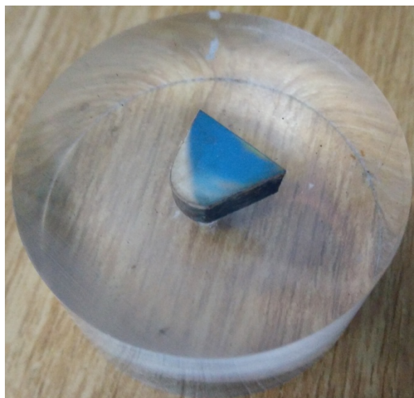
Slika 36. Uzorak noža malčera u kalupu
