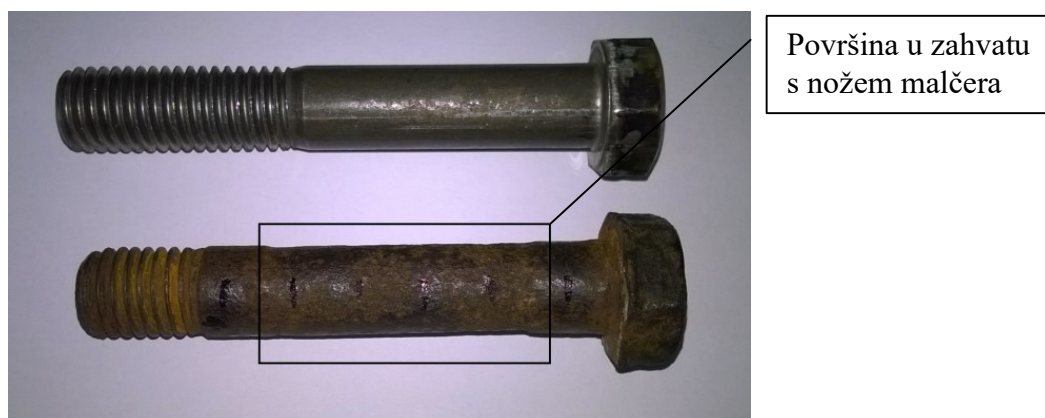
Slika 40. Usporedba korištenog i nekorištenog vijka
