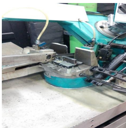
Slika 30. Rezanje makroizbruska tračnom pilom
