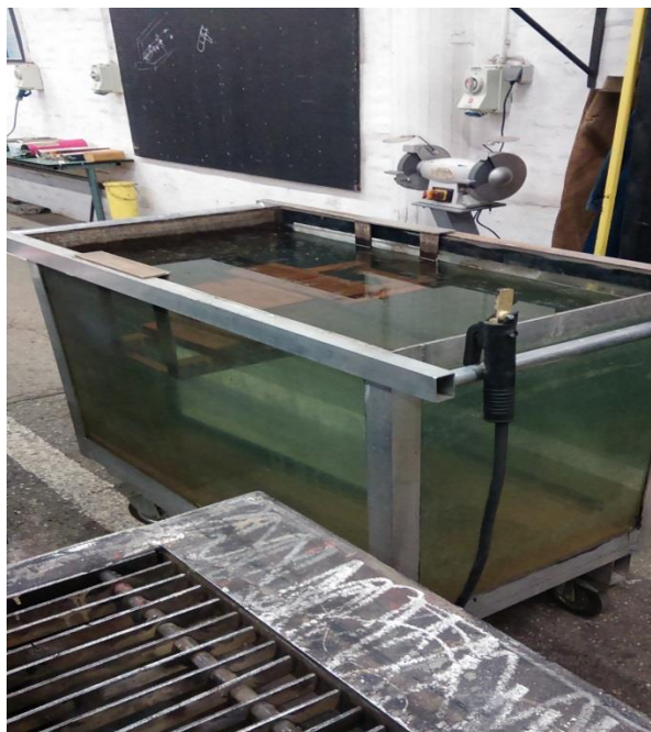
Slika 20. Bazen za podvodno zavarivanje
