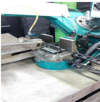
Slika 30. Rezanje makroizbruska tračnom pilom
