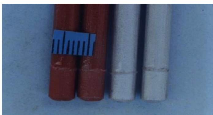
Slika 7. Rutilne elektrode za mokro podvodno zavarivanje s dvostrukim vodonepropusnim premazom [11]
