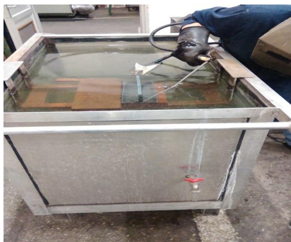
Slika 25. Pozicioniranje držača elektrode za početak zavarivanja kutnog spoja
