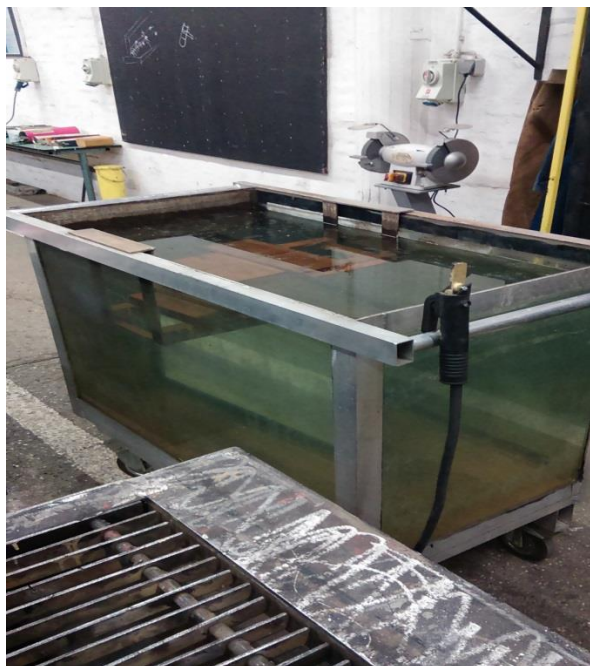
Slika 20. Bazen za podvodno zavarivanje
