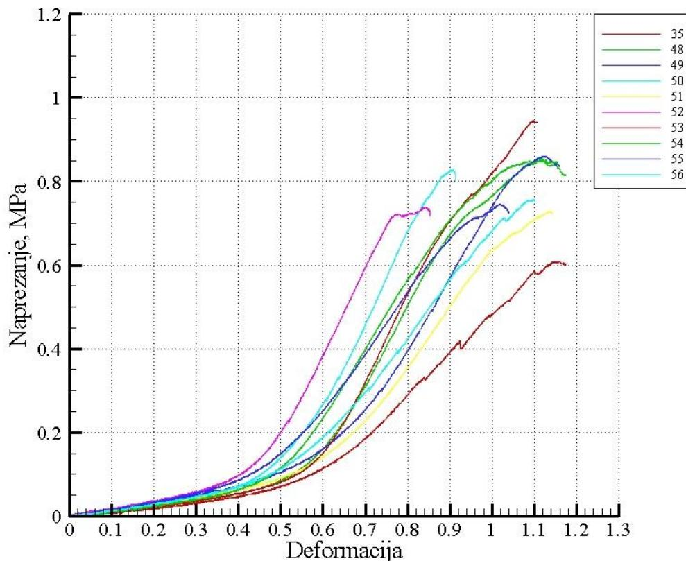
**Slika 24.** Dijagram naprezanje-deformacija za abdominalne aorte bez predkondicioniranja
