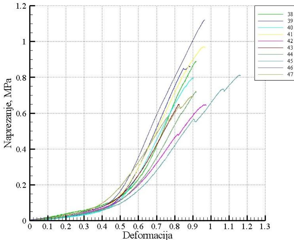
Slika 21. Dijagram naprezanje-deformacija za torakalne aorte bez predkondicioniranja
