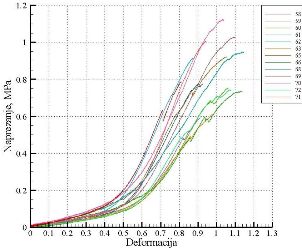
**Slika 22. Dijagram naprezanje-deformacija za torakalne aorte s predkondicioniranjem**
