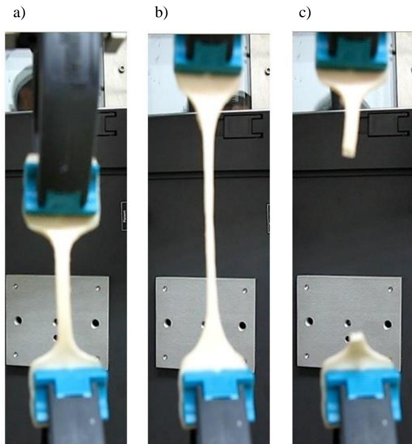
**Slika 19. Ispitivanje uzorka: a) početak ispitivanja, b) opterećen uzorak, c) puknuće uzorka**
