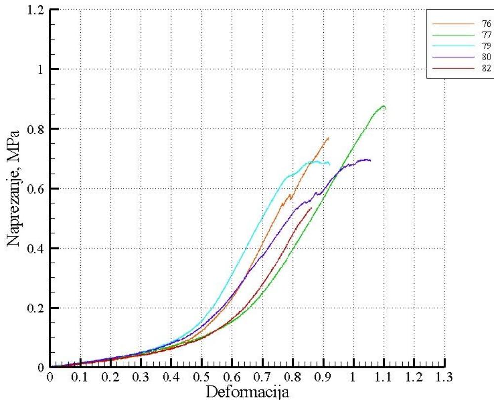
**Slika 25. Dijagram naprezanje-deformacija za abdominalne aorte s predkondicioniranjem**
