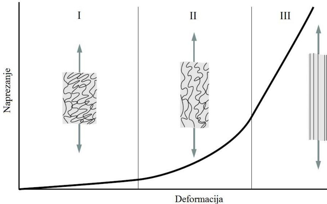
**Slika 4. Odnos naprezanja i deformacije pri vlačnom ispitivanju [9]**
