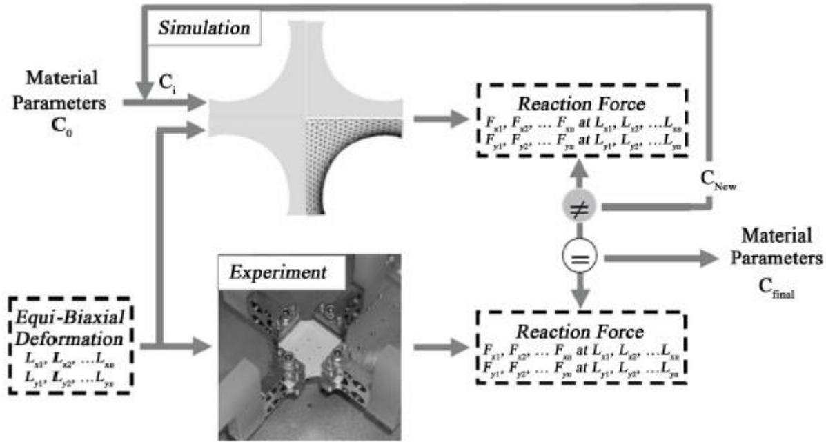
Slika 10. Postupak određivanja svojstava materijala inverznim modeliranjem [17]
