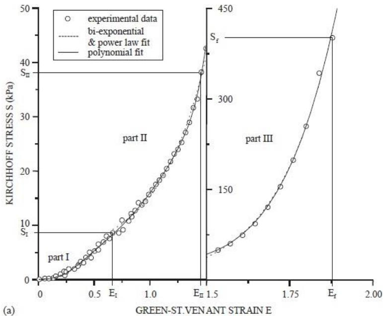
Slika 12. Krivulja naprezanje-deformacija podijeljena u tri dijela [18]
