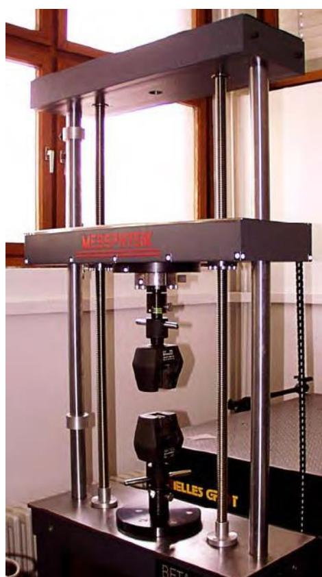
Slika 13. Statička kidalica Messphysik Beta 50-5
