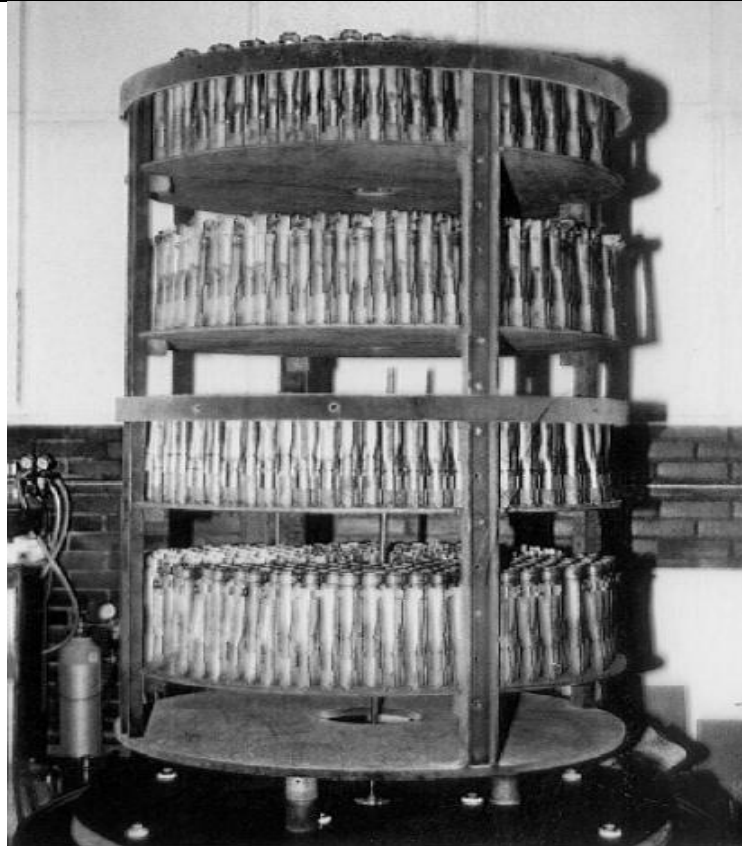
Slika 20 Šaržiranje pri velikoserijskoj proizvodnji [21]
