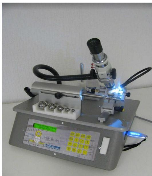
**Slika 22** Uređaj za određivanje debljine prevlake [23]
