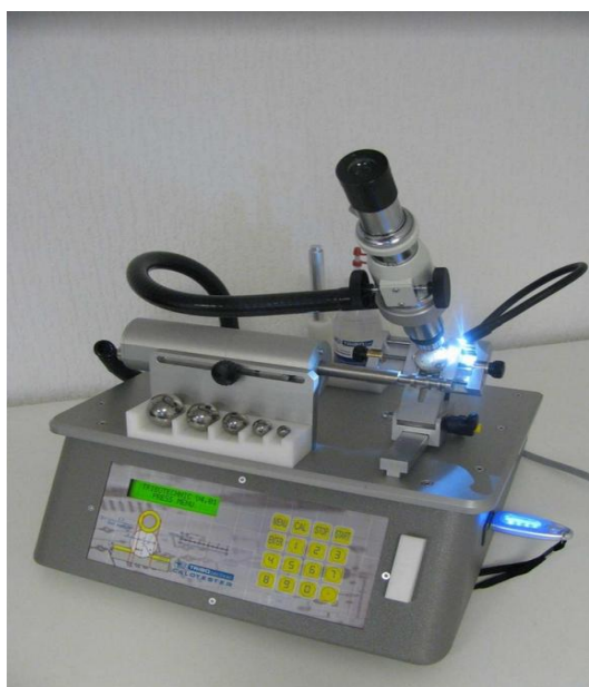
Slika 22 Uređaj za određivanje debljine prevlake [23]
