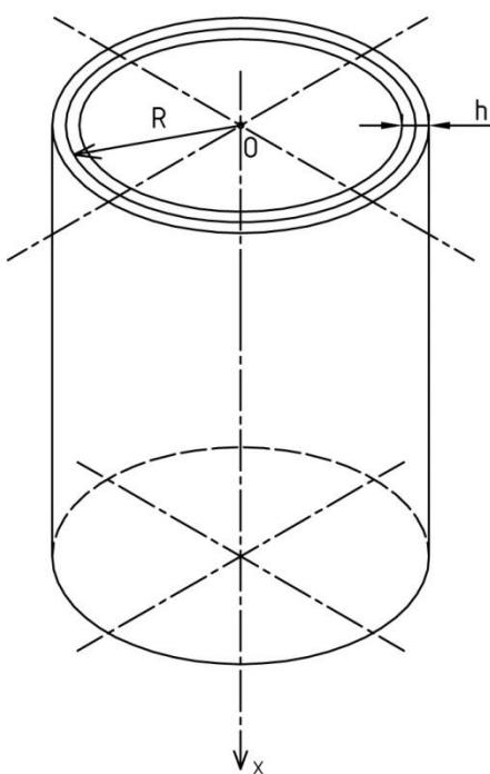
Slika 10. Cilindrična ljuška
