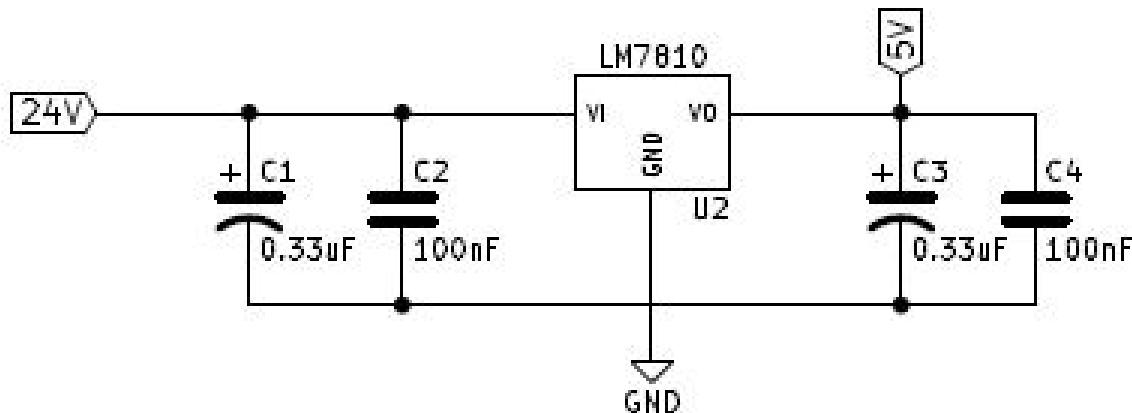
Slika 9: Stabilizator napona oznake LM7810
