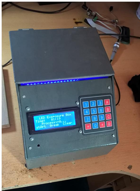
Slika 12: Svjetlosna obrada u uređaju za osvjetljavanje
