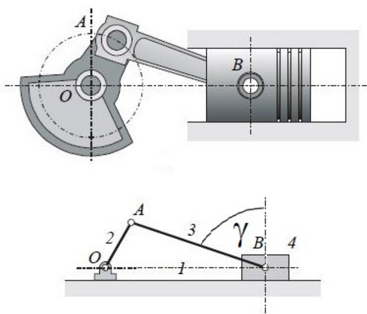
Slika 3: Kinematička shema mehanizma<sup>1</sup>
