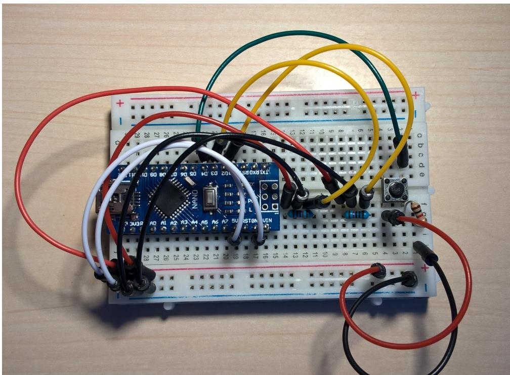
Slika 10: Mikrokontroler na eksperimentalnoj ploči za elektroniku
