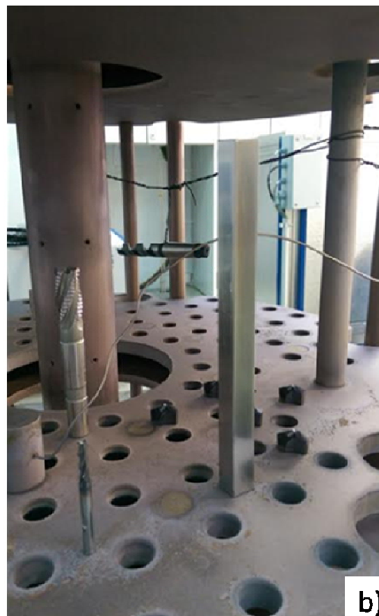
Slika 4.1. Uzorak od čelika X38CrMoV5–3. Oblik i dimenzije uzorka (a) i smještaj u reaktoru PACVD uređaja (b) [13]
